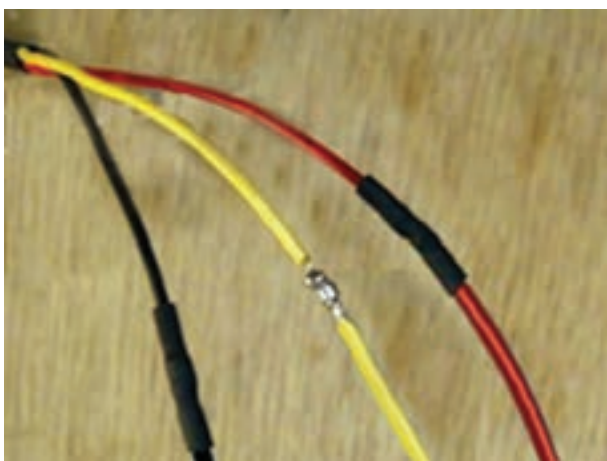
شکل ۱-۷۴- رفع عیب سیم کشی مدار الکتریکی
