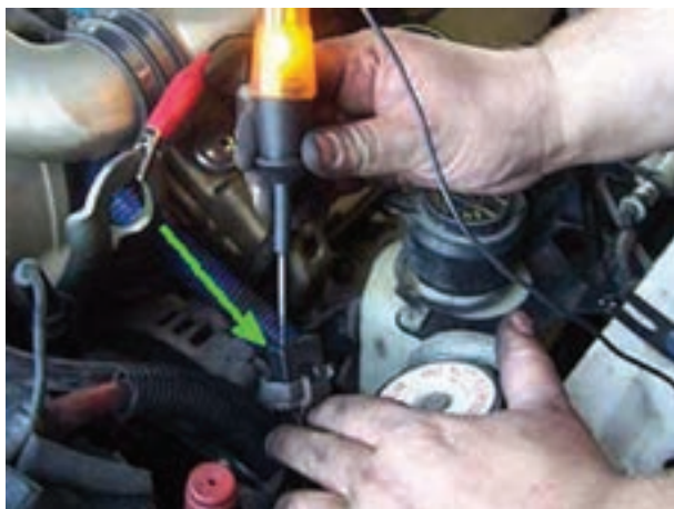
شکل ۱-۷۳- آزمایش سیم کشی مدار
