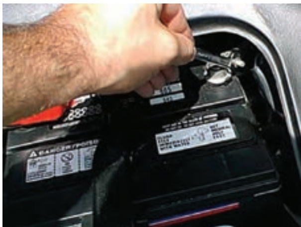
شکل ۱۲-۳- بستن کابل اتصال بدنه‌ی باتری
