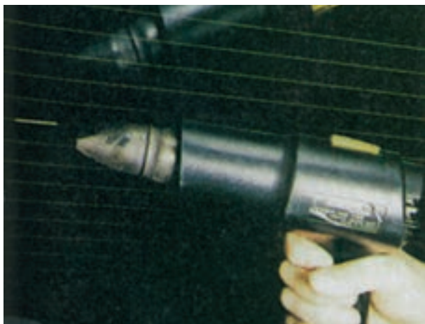
شکل ۳-۲۷- حرارت دادن محل تعمیر
