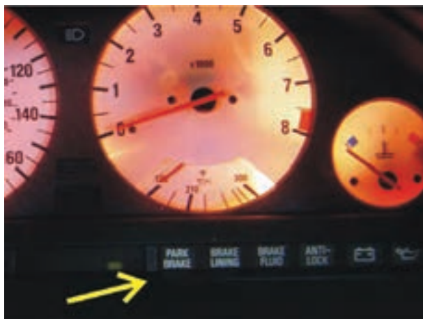
شکل ۱-۲۰۵- چراغ‌های اخطار سیستم ترمز
