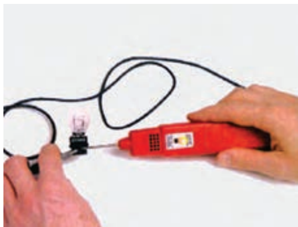
شکل ۲۱۹-۱- آزمایش لامپ چراغ صندوق عقب خودرو
