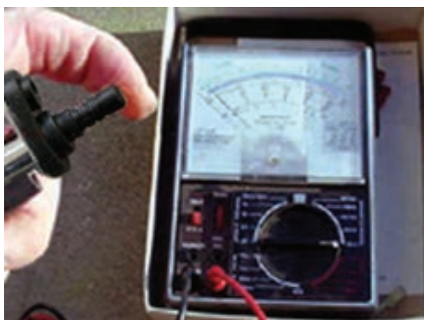
شکل ۱۹۶-۱- آزمایش سوئیچ لای در
