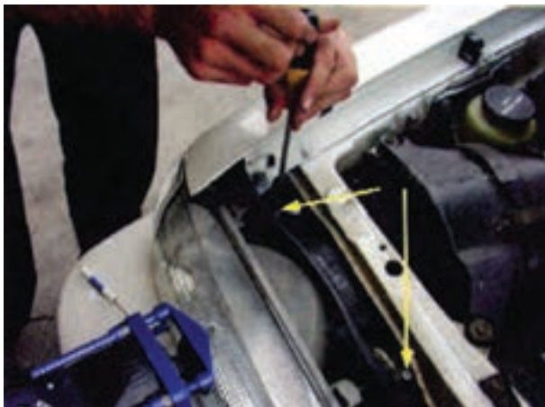
شکل ۱۶۷-۱- پیچ‌های تنظیم چراغ بزرگ جلو
