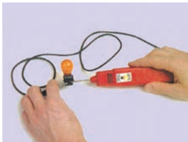
شکل ۱۸۲-۱- آزمایش لامپ چراغ راهنما
