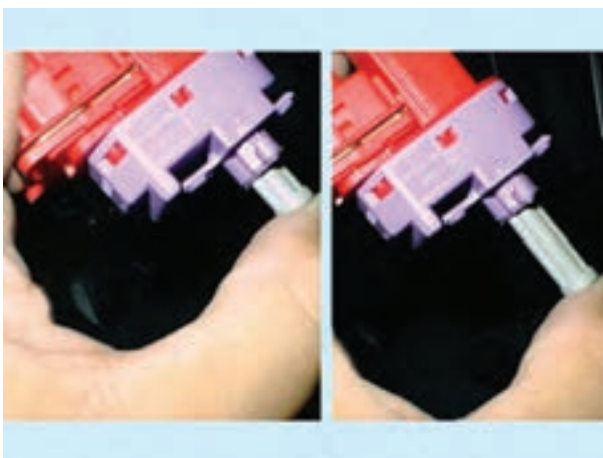
شکل ۱-۱۹۹- عملکرد پلانجر سوئیچ جعبه‌ی داشبورد
