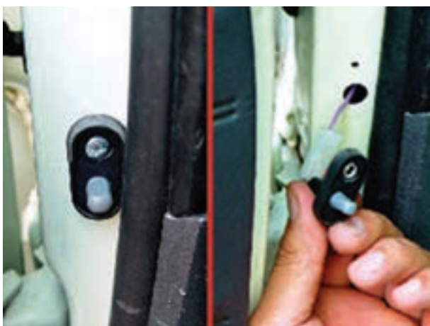
شکل ۱۹۲-۱- باز کردن سوئیچ لای در
