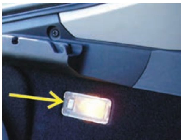
شکل ۲۱۸-۱- چراغ صندوق عقب و سوئیچ روی آن
