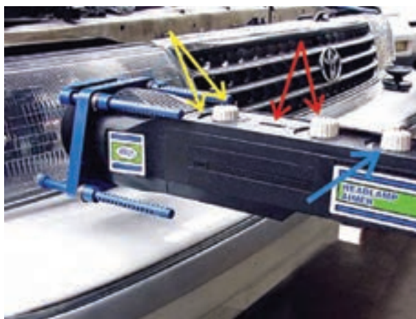
شکل ۱۶۱-۱- پیچ‌های تنظیم دستگاه تنظیم نور چراغ‌ها
