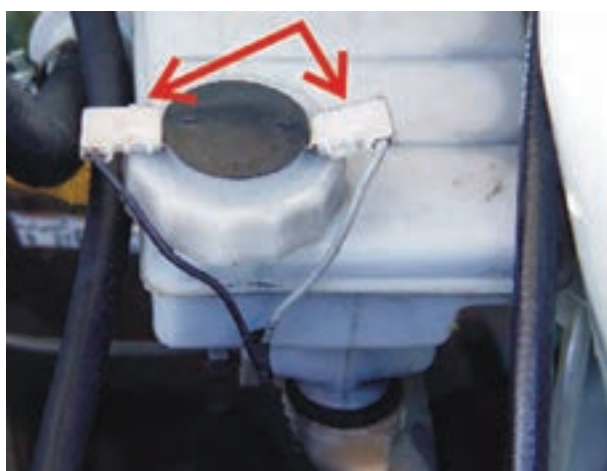
شکل ۲۰۳-۱- سوکت های اتصال پلاتین ها
