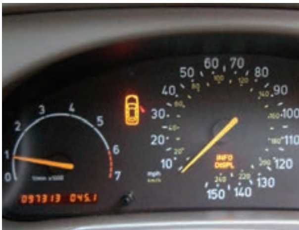
شکل ۲۱۳-۱- چراغ اخطار بازبودن درهای خودرو
