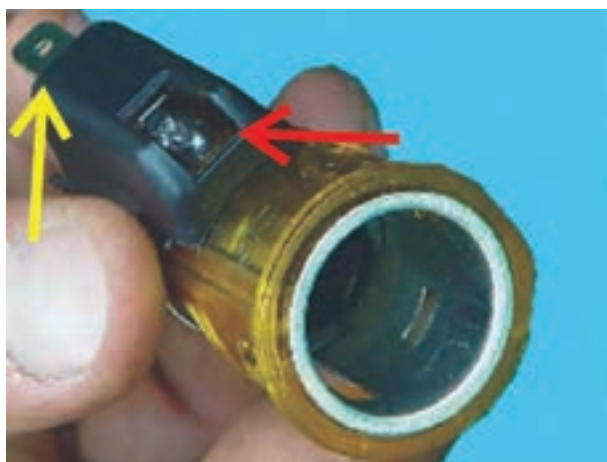
شکل ۱-۲۲۴- لامپ فندک و ترمینال الکتریکی آن
