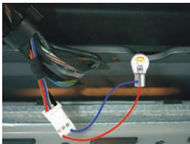
شکل ۱-۲۳۷- آزمایش سیم کشی مدار چراغ فندک
