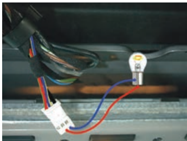
شکل ۱-۲۳۶- آزمایش سیم کشی مدار فندک
