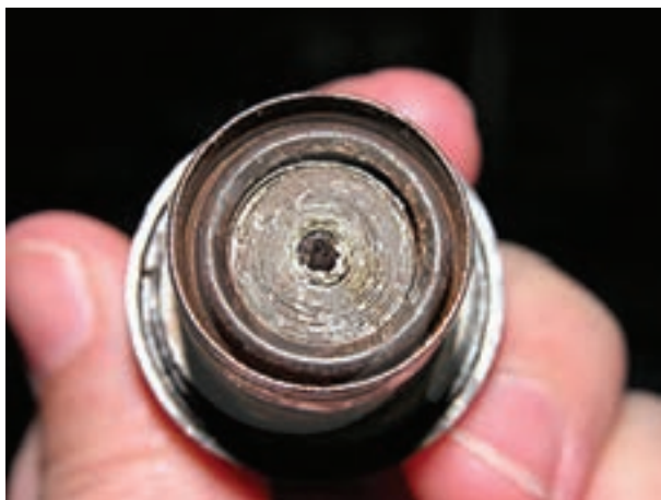
شکل ۱-۲۲۵- المنت حرارتی داخل سوئیچ فشاری
