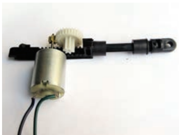
شکل ۲۰-۲- نحوه‌ی ارتباط چرخ‌دنده‌ها هنگام تبدیل دور
