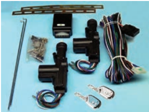
شکل ۱-۲- اجزای مدار قفل مرکزی
