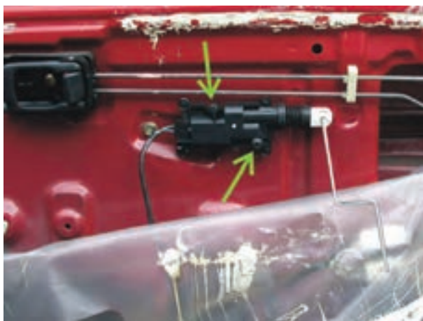
شکل ۲-۲۹ اتصال عملگر الکتریکی در روی در خودرو
