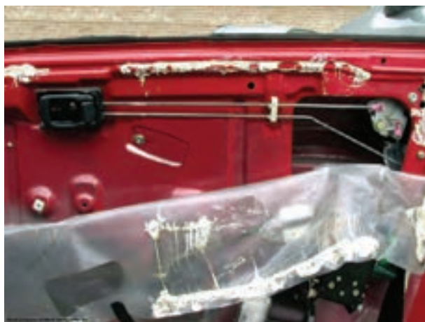
شکل ۲۶-۲- جدا کردن پلاستیک محافظ روی در
