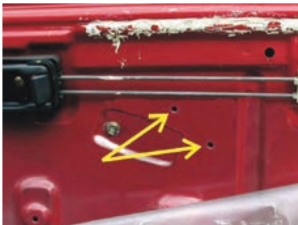
شکل ۲-۲۷ سوراخ کاری بدنه‌ی داخلی در خودرو
