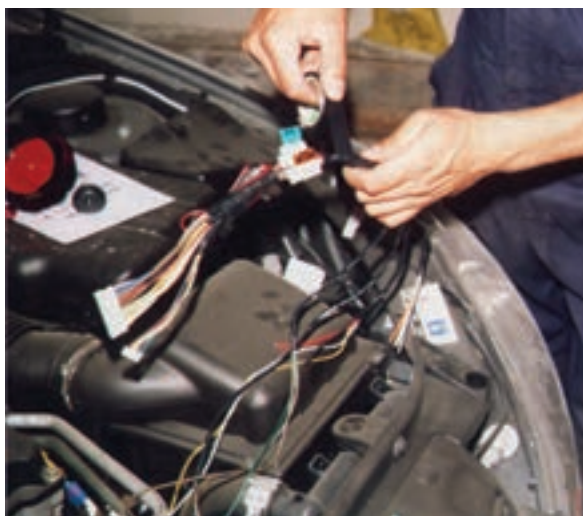
شکل ۲-۷۷ - نحوه‌ی عایق‌بندی سیم‌های مدار الکتریکی دزدگیر
