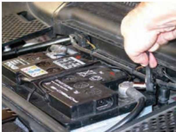
شکل ۲-۳۳- باز کردن اتصال بدنه‌ی باتری
