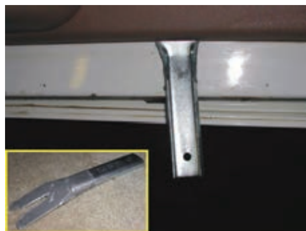
شکل ۲-۳۵- اهرم خاردرآر و نحوه‌ی استفاده از آن
