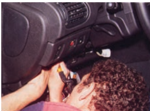
شکل ۲-۹۵ آزمایش برقراری جریان الکتریکی مدار
