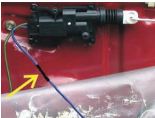
شکل ۲-۴۹- عایق کاری محل اتصال سیم‌ها به یکدیگر
