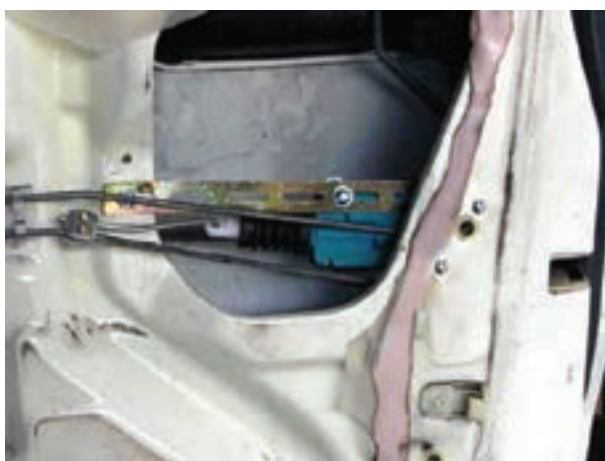
شکل ۲-۳۷- نحوه‌ی اتصال عملگر الکتریکی
