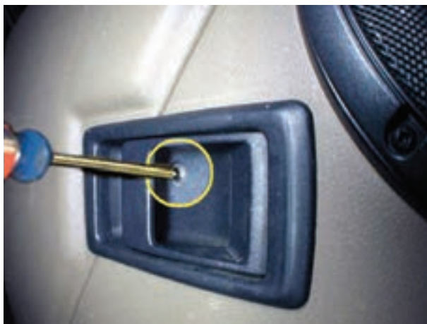
شکل ۲-۳۶- باز کردن قاب دستگیره‌ی قفل در
