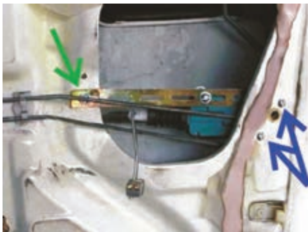
شکل ۳۹-۲- باز کردن پیچ‌های اتصال عملگر الکتریکی
