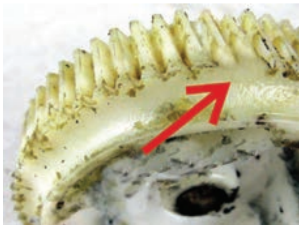
شکل ۱۲۷-۲ وجود عیب در چرخ دنده
