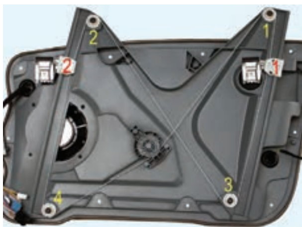
شکل ۱۰۶-۲- نحوه‌ی ارتباط رگلاتورهای مکانیزم شیشه بالابر
