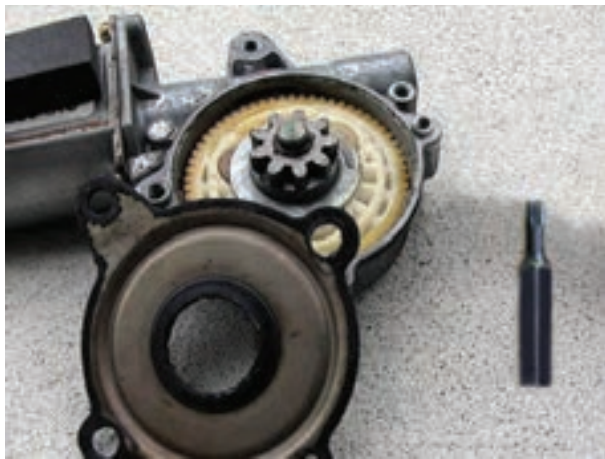
شکل ۱۲۴-۲- اجزای داخل جعبه دنده‌ی تعدیل دور
