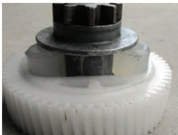
شکل ۱۲۸-۲ سوار کردن چرخ دنده‌ی فلزی
