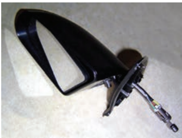
شکل ۱۵۶-۲- آینه‌ی جانبی و مکانیزم حرکت آن
