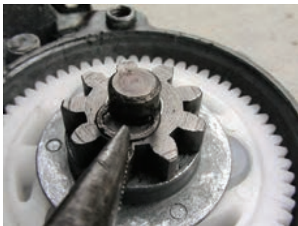
شکل ۱۲۹-۲ جانداختن خار فنری
