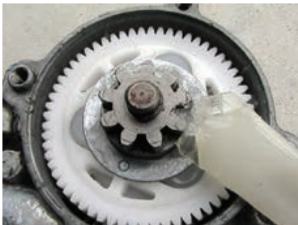
شکل ۱۳۰-۲- روغن کاری چرخ دنده ها
