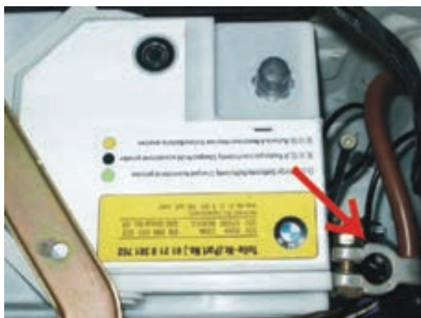
شکل ۲-۱۰۹- باز کردن اتصال منفی باتری
