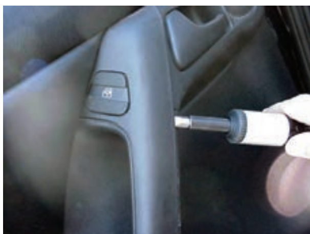
شکل ۲-۱۱۰- جدا کردن قاب سوئیچ شیشه بالابر
