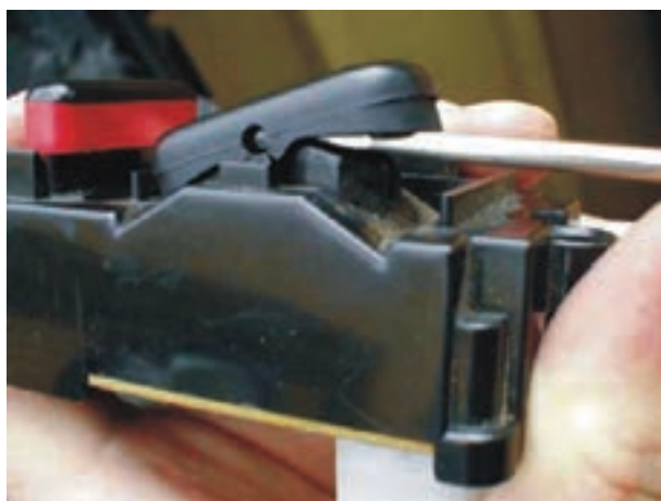
شکل ۲-۱۴۵- تعویض شستی معیوب
