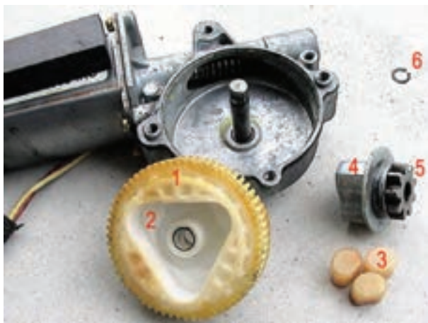
شکل ۱۲۵-۲- اجزای داخل پوسته‌ی گیربکس تعدیل دور
