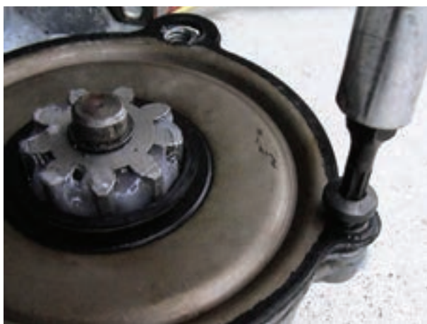
شکل ۱۳۱-۲- بستن پیچ های درپوش به بدنه
