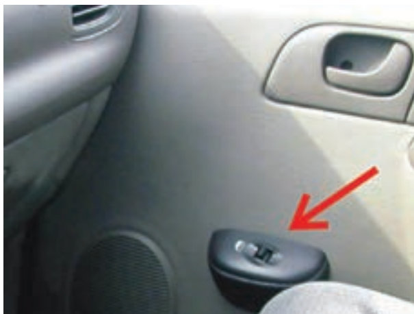
شکل ۱۳۳-۲- سوئیچ شیشه بالابر در جلو سمت سرنشین
