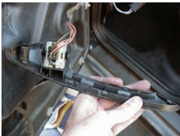
شکل ۱۱۸-۲- اتصال سوکت سوئیچ شیشه بالابر
