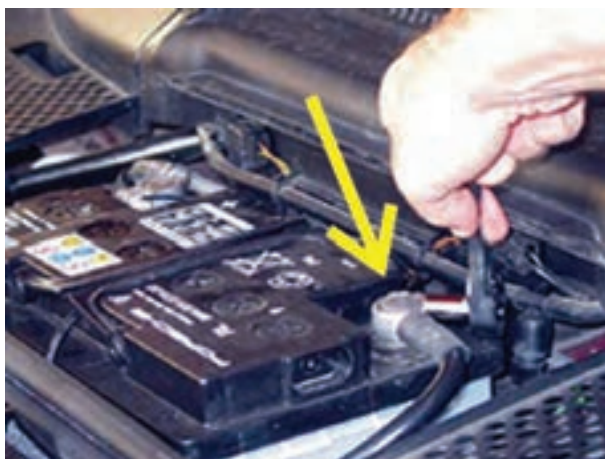
شکل ۱۴۱-۲- باز کردن کابل اتصال بدنه‌ی باتری
