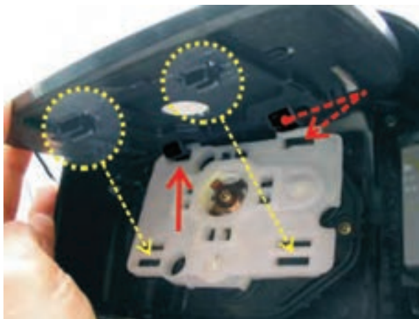
شکل ۱۶۲-۲ زائده‌ها و خارهای اتصال آیینی به صفحه‌ی زیرین
