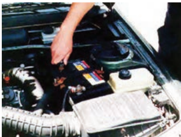
شکل ۱۶۴-۲ بازکردن کابل اتصال بدنه‌ی باتری
