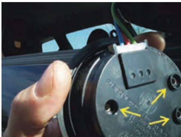
شکل ۱۷۲-۲- جدا کردن محفظه‌ی موتورهای الکتریکی
