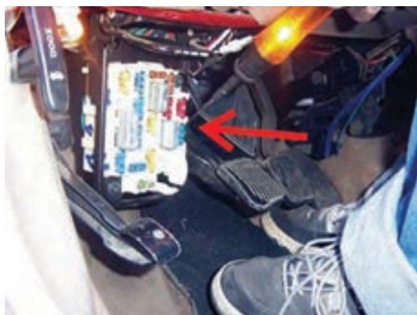
شکل ۱۸۹-۲- آزمایش پایه‌های فیوز
