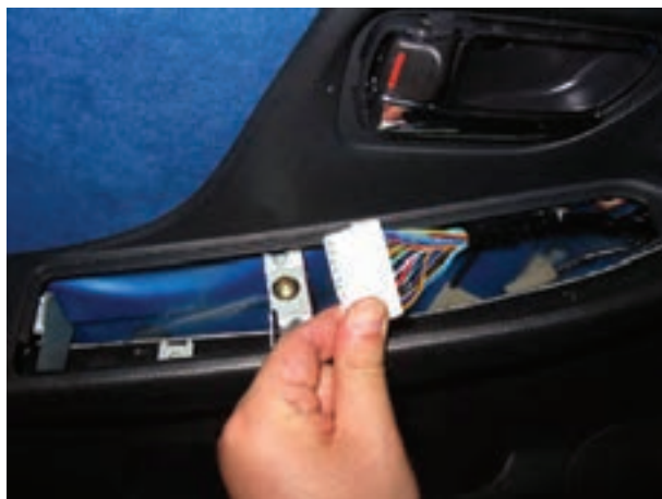
شکل ۱۸۵-۲- سوکت اتصال دسته سیم به سوئیچ‌ها
