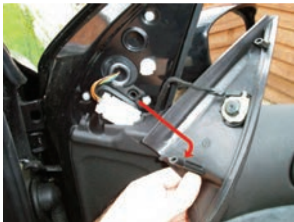
شکل ۱۶۵-۲ خارهای روی قاب و محل نصب آن
