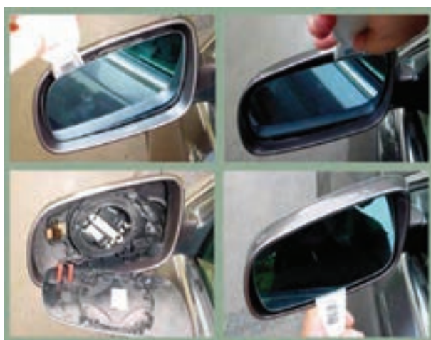
شکل ۱۶۷-۲- بیرون آوردن آینه از داخل قاب آن
