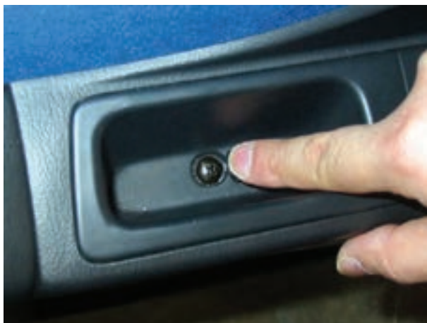
شکل ۱۸۲-۲ پیچ اتصال قاب سوئیچ به بدنه
