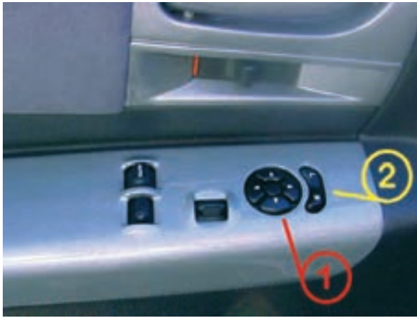
ب- مجموعه‌ی سوئیچ آینه‌های جانبی و شیشه بالابر شکل ۱۸۰-۲- سوئیچ آینه‌های جانبی
