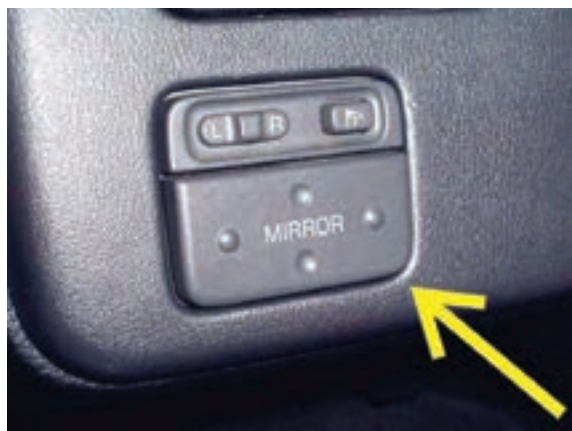
الف- سوئیچ آینه‌های جانبی یک نوع خودرو
