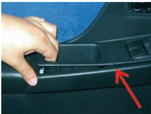
شکل ۱۸۳-۲ خارج نمودن قاب سوئیچ‌ها
