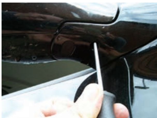
شکل ۱۷۶-۲- بازکردن پیچ روی پایه ی بیرونی آینه
