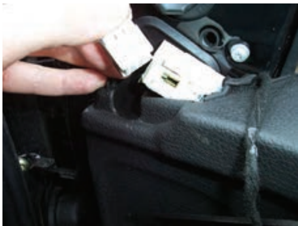
شکل ۱۶۶-۲- جدا کردن سوکت سیم کشی آینه
