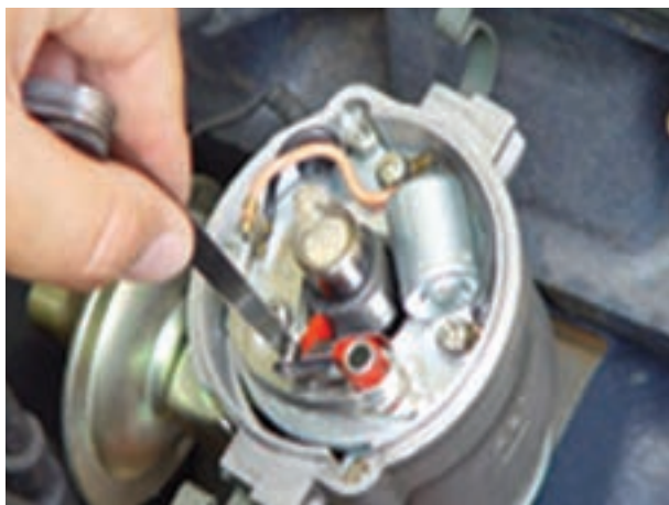
شکل ۴۸-۱۰- قرار دادن فیلر در دهانه‌ی پلاتین
