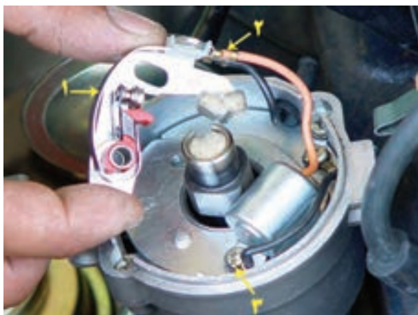
۱- پلاتین ۲- محل اتصال سیم خازن به پلاتین ۳- پیچ اتصال خازن شکل ۳۹- ۱۰
