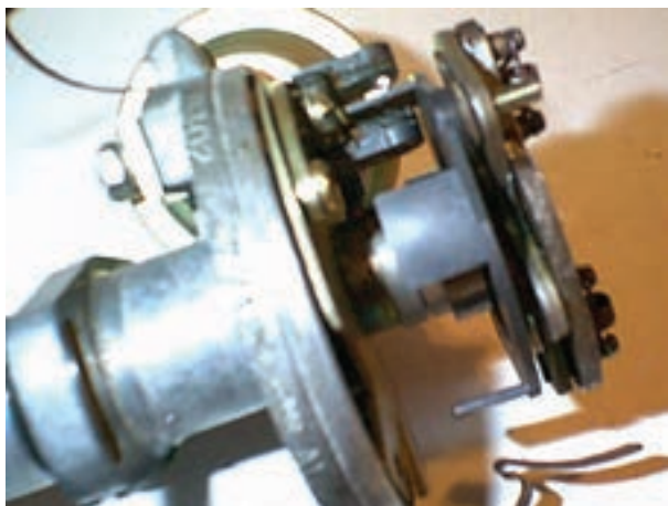
شکل ۷۳-۱۰- دلقوی الکترونیکی با حسگر اثرهال
