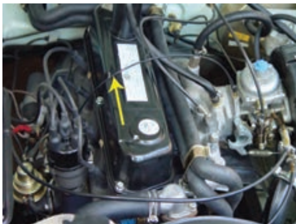
شکل ۲۸-۱۰- لوله‌ی رابط آوانس خلتی به کاربراتور
