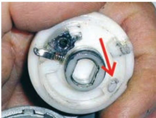
شکل ۱۱-۲۵- آسیب دیدن تکیه‌گاه فنر در روی فیبری سوئیچ
