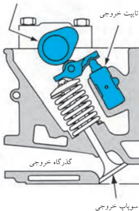
میل بادامک سوپاپ‌های خروجی
