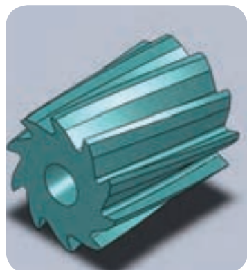
تیغه فرز دارای لبه‌های برنده مارپیچ
