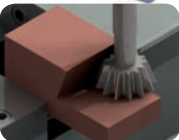
نمونه‌هایی از قطعات دارای سطح شیب‌دار
