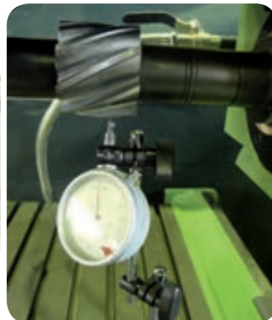
کنترل دور بودن تیغه فرز از لنگی با ساعت اندازه گیری
