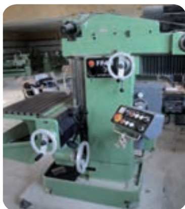
فلکه‌های دستگاه برای جابجایی دستی
