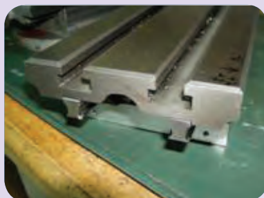
نمونه شیارهای T شکل
