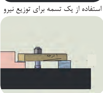
شیب روبند به سمت قطعه کار
