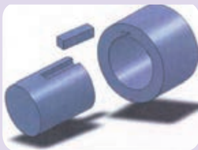
نمونه شیارهای راست گوشه
