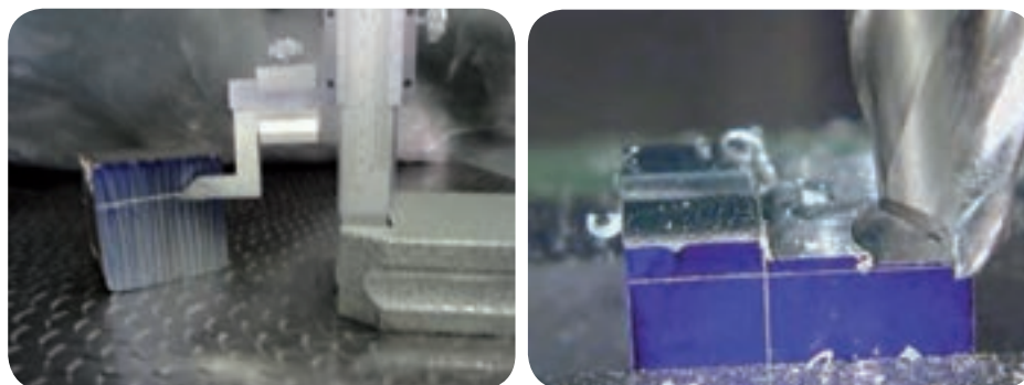
خط‌کشی قطعه کار جهت کنترل بهتر در هنگام براده برداری
