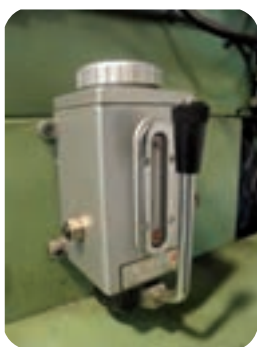
دو نمونه نمایش گر سطح روغن دستگاه
