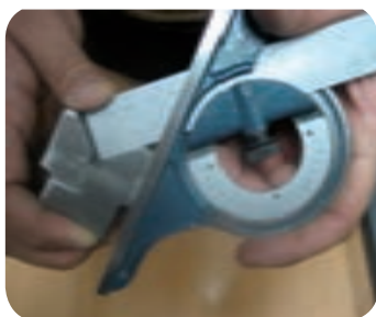
کنترل شیب قطعه با زاویه سنج انیورسال
