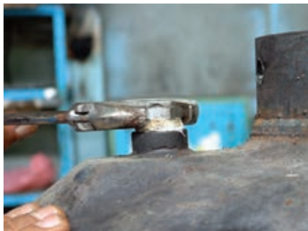
شکل ۱-۲۴- نحوه‌ی بازکردن میله‌ی منیزیم از محل خود
