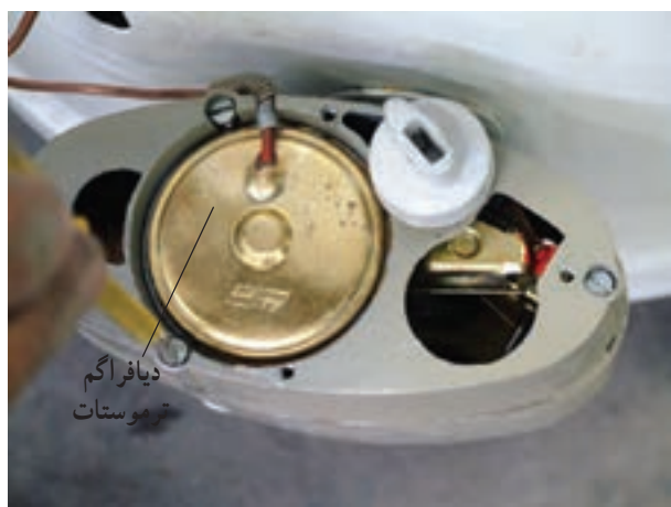
شکل ۵۵-۱- ب - دیافراگم ترموستات
