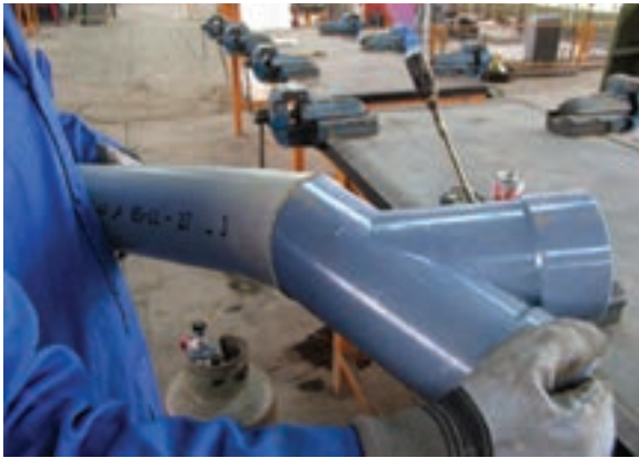
شکل ۲-۹- درست کردن سرکاسه
