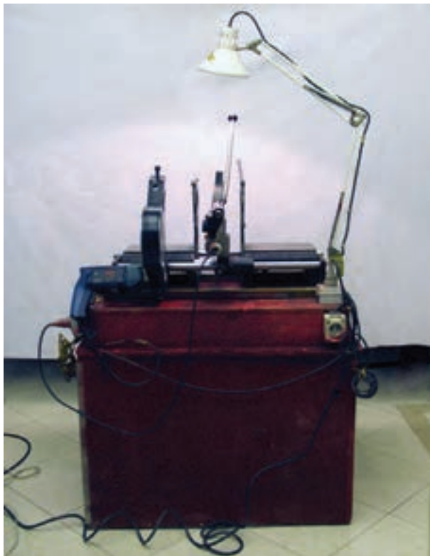
شکل ۲-۳۷- دستگاه جوش لوله و فیتینگ پلی اتیلن
