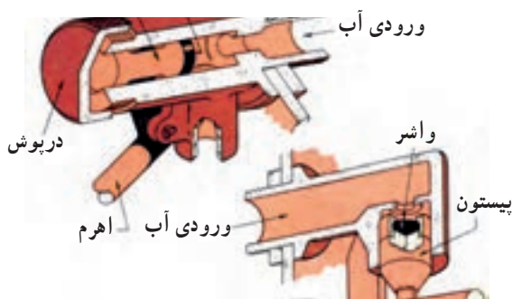
شکل ۱۱۳-۲ اجزای شیر شناور
