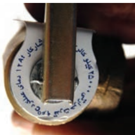
شکل ۲-۱۰۸- شیر اطمینان فشاری و حرارتی
