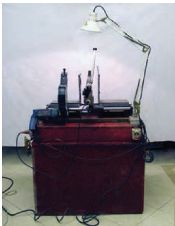
شکل ۲-۳۷- دستگاه جوش لوله و فیتینگ پلی اتیلن
