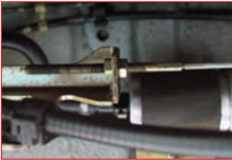
شکل ۴۸-۱- باز کردن مهره تنظیم کننده
