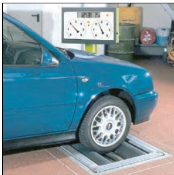
شکل ۱-۷۴- دستگاه آزمایش دینامیکی ترمز
