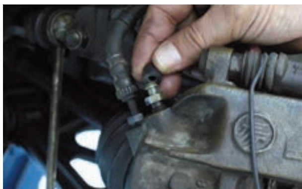
شکل ۱-۷۰- پاک کردن اطراف پیچ هواگیری
