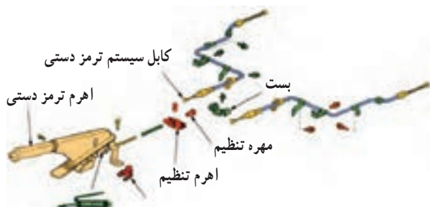
شکل ۱-۴۶-ا- اجزای سیستم ترمز دستی
