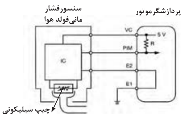
شکل ۲-۲۷ مدار الکترونیکی سنسور فشاری مانی فولد هوای ورودی
