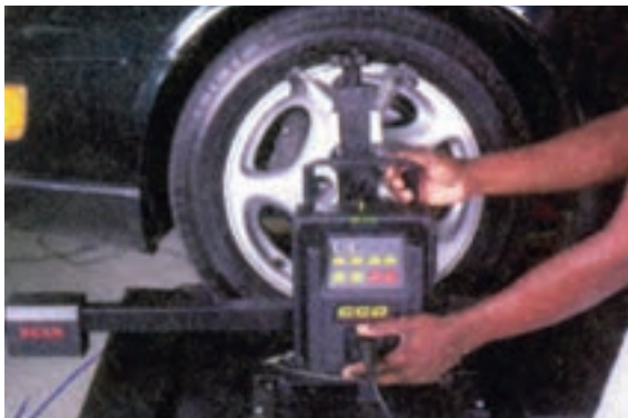
شکل ۳-۲۲۰ - نصب مجموعه حسگر دستگاه اندازه‌گیر رایانه‌ای
