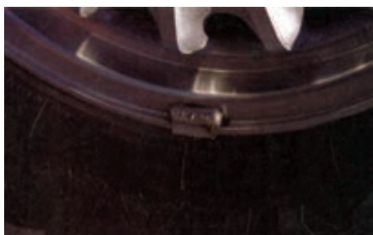
شکل ۳-۲۳۱- نصب وزنه روی رینگ
