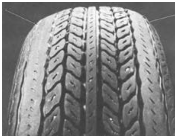
شکل ۲۱۴-۳- سایش در اثر رانندگی غلط (پیچیدن تند)
