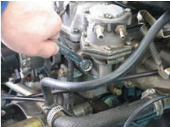
شکل ۱-۴۲ پیاده کردن پمپ
