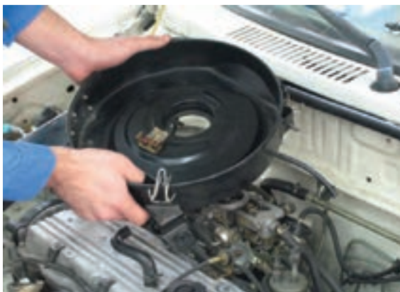
شکل ۱۰۰-۱ پیاده کردن مجموعه هواکش
