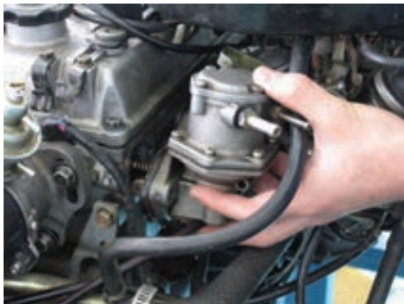
شکل ۱-۴۴ الف: نصب پمپ
