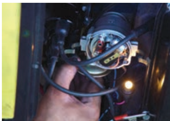
شکل ۹۲-۳- لحظه باز شدن دهانه پلاتین و روشن شدن لامپ
