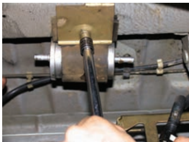
شکل ۱-۴۸ نصب فیلتر جدید
