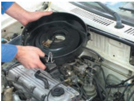
شکل ۱۱۴- ۱ پیاده کردن مجموعه هواکش
