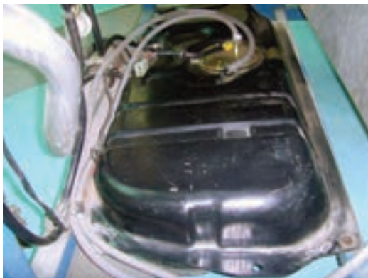
شکل ۱-۲۷ مخزن نصب شده و آماده سوخت گیری
