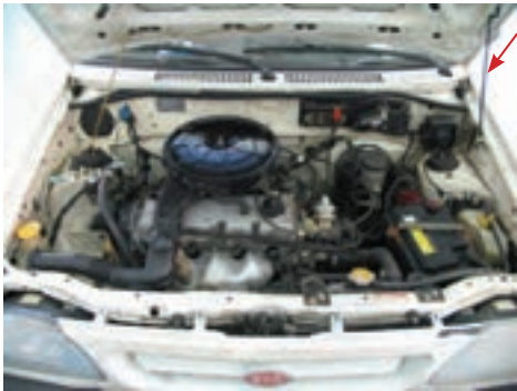
شکل ۱۱۹- ۱ نصب صحیح اهرم نگه‌دارنده درپوش موتور خودرو
