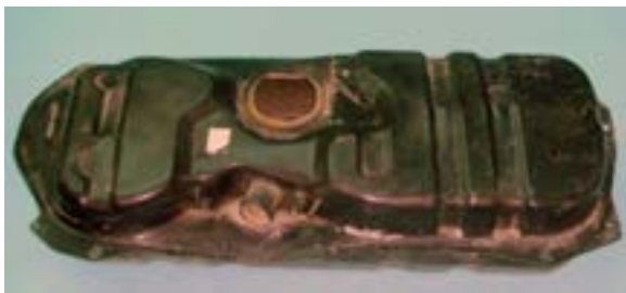
شکل ۱-۲۶ مخزن سوخت آماده نصب
