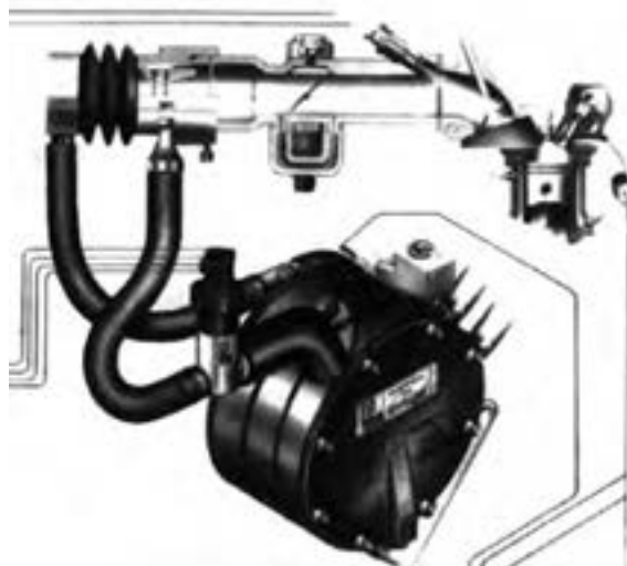
شکل ۱۵-۱- سیستم مخلوط‌کننده سوخت گاز با هوا
