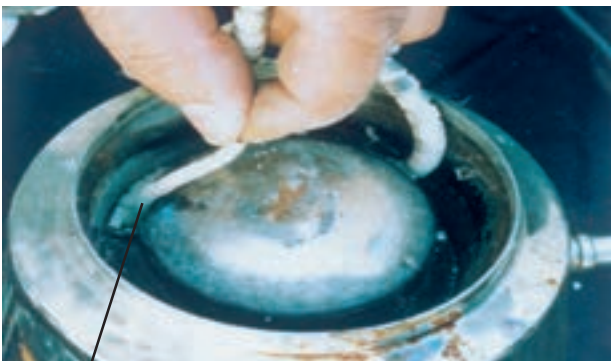
شکل ۲-۲۱ محلی که عایق بندی ضعیف است
