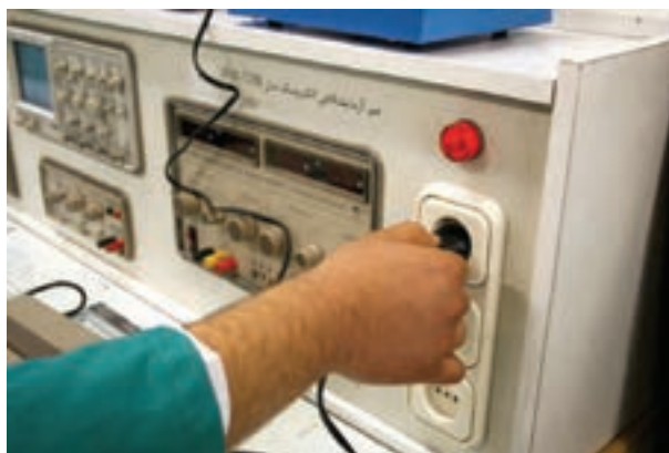
شکل ۱-۳۸ اتصال صحیح دو شاخه
