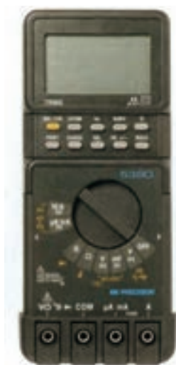
شکل ۱-۵۵ یک نمونه مولتی متر دیجیتالی دارای حوزه (رنج) اندازه‌گیری ظرفیت
