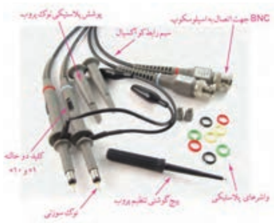
شکل ۵-۶ پروب و اجزای آن
