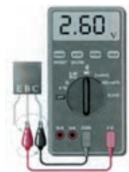
شکل ۴۹-۱۲ ترانزیستور معیوب (قطع)
