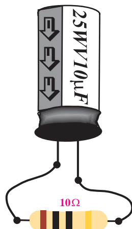
شکل ۷-۵۴ تخلیه‌ی خازن
