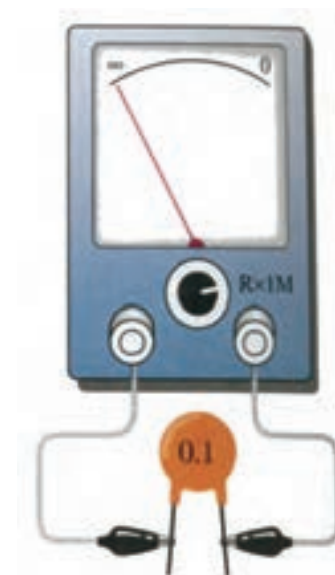
شکل ۷-۵۱ خازن قطع است
