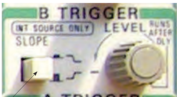
شکل ۶-۳۱ ولوم -/+ slope
