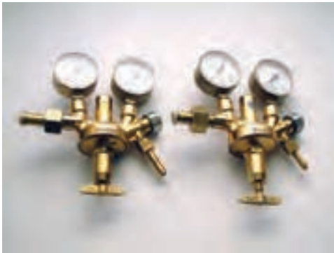
شکل ۲-۴۵- رگولاتور اکسیژن و استیلن
