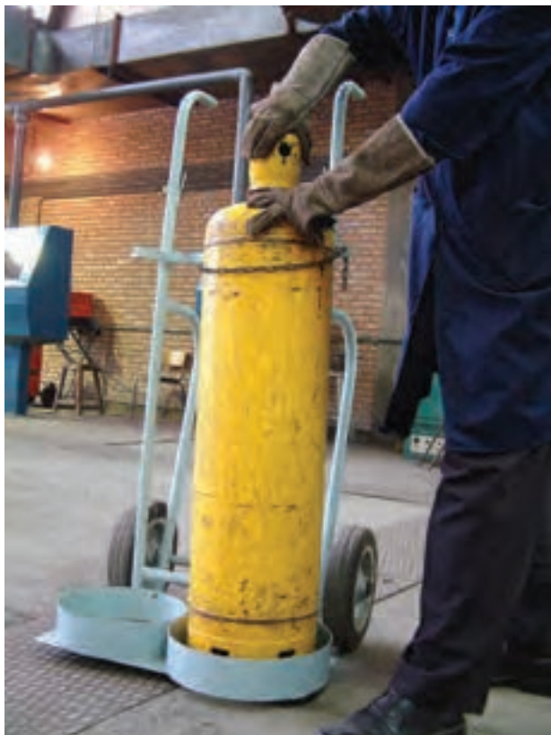
شکل ۲-۱۹- کپسول استیلن و کلاهک آن
