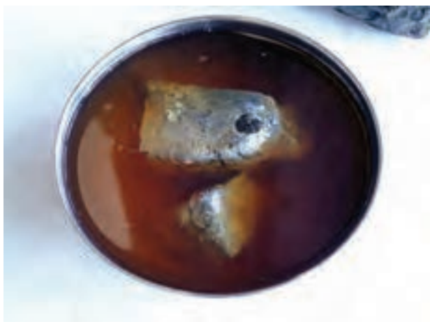
شکل ۱۲-۲ نگهداری کاربید در زیر نفت
