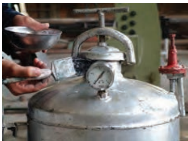
شکل ۲-۳۸- کنترل نشتی گاز
