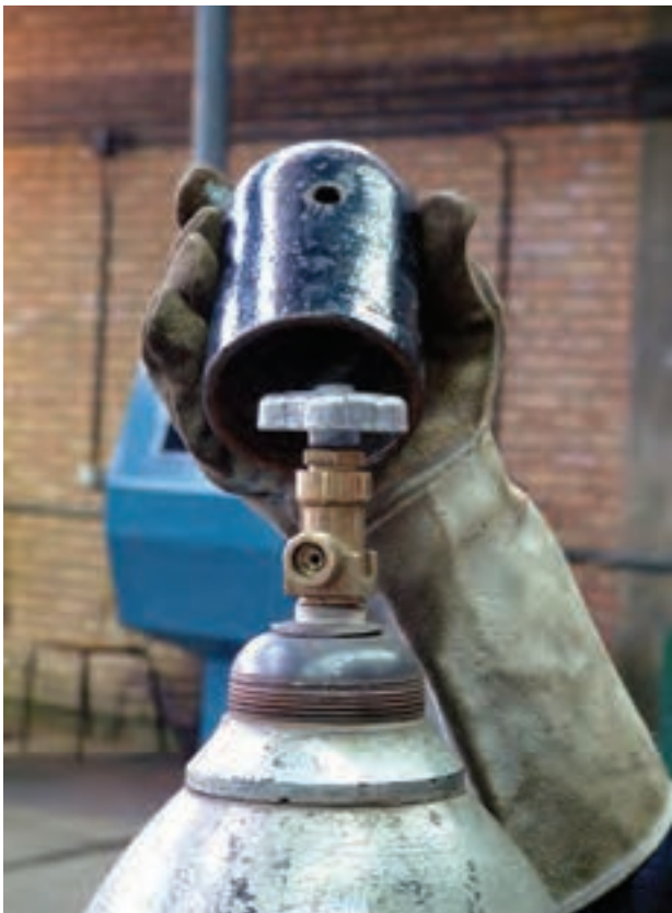
شکل ۲-۱۷- کلاهک کپسول اکسیژن
