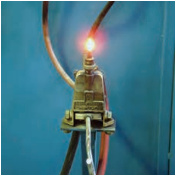
شکل ۲-۶۸- شمعک روی میز جوشکاری گاز
