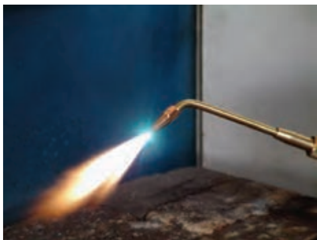
شکل ۲-۳- شعله‌ی سوختن گاز استیلن با اکسیژن
