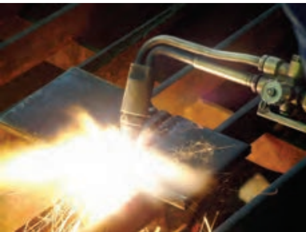
شکل ۲-۶- برشکاری با گاز
