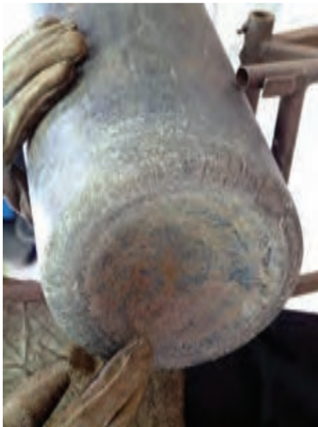
شکل ۲-۱۸- گودی ته کپسول اکسیژن
