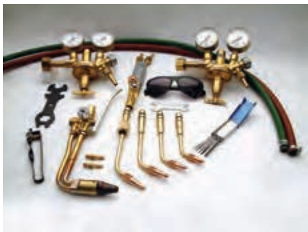
شکل ۱۵-۲ - تجهیزات جوشکاری با شعله‌ی گاز
