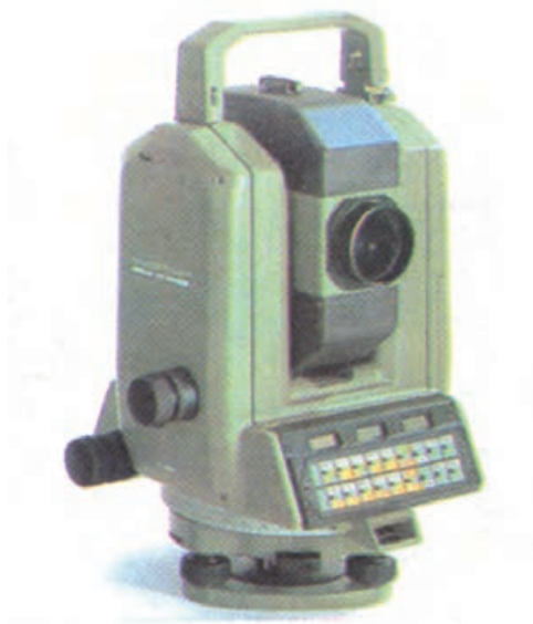
شکل ۲۴-۴ فاصله‌یاب در داخل دوربین نقشه‌برداری
