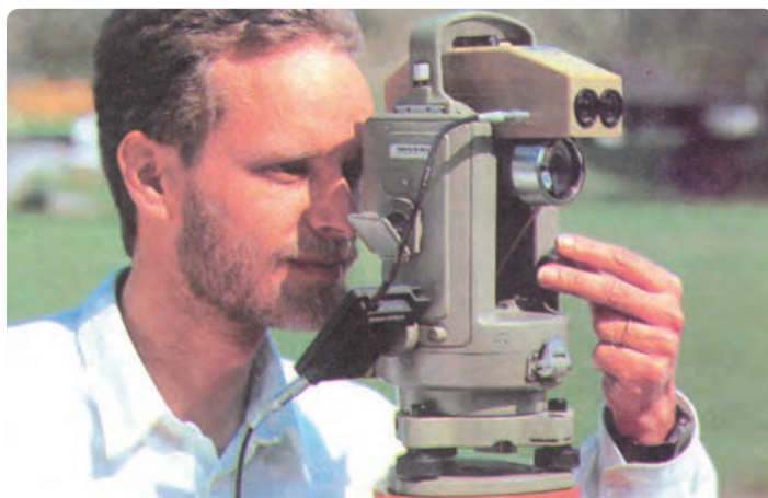
شکل ۲۳-۴ نصب فاصله‌یاب روی دوربین
