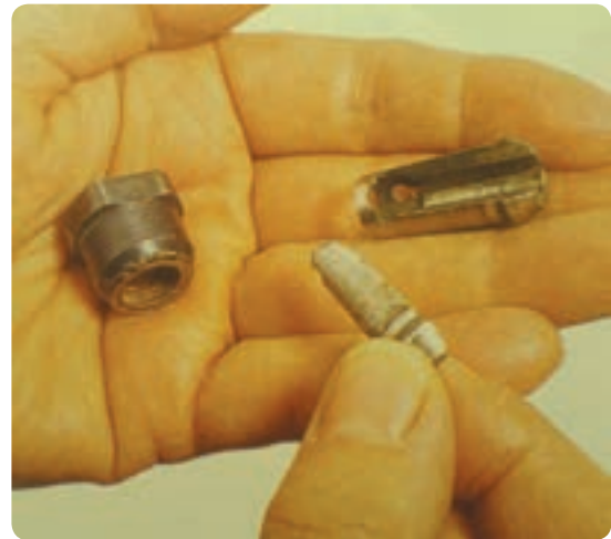
شکل ۲-۴۱ بوش تیغه اور فرز همراه با مهره سفت‌کننده تیغه روی شفت دستگاه
