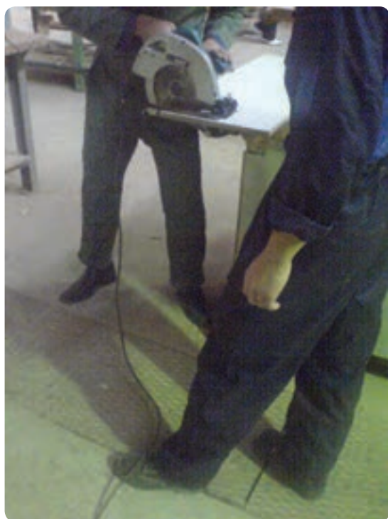
شکل ۲۷-۲ سیم سیار در مسیر نباشد
