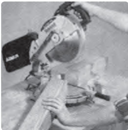
شکل ۲-۱۳- برش تحت زاویه
