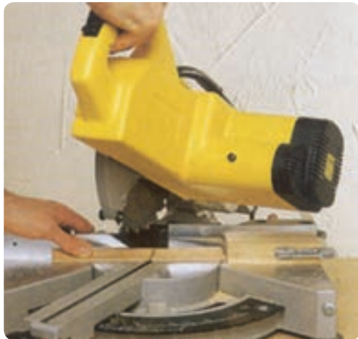
شکل ۲-۱۲- برش قائم با اره گرد فارسی بر
