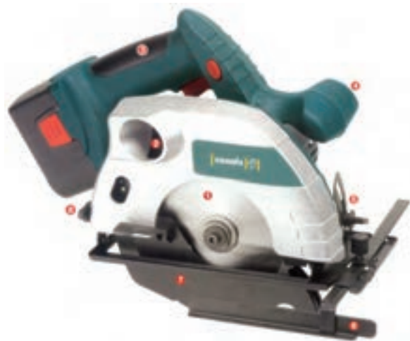
شکل ۲۱-۲ تنظیمات ماشین اره گرد دستی برقی
