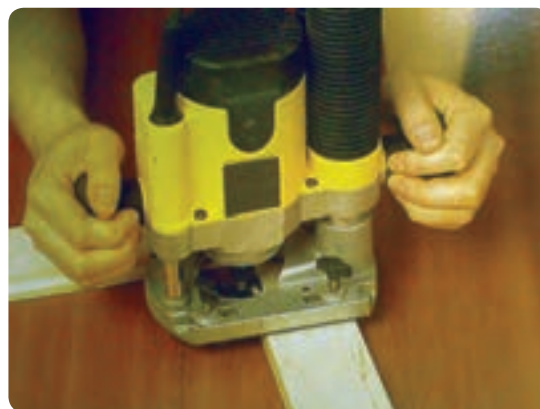
شکل ۵۹-۲ فرز کاری داخل قاب
