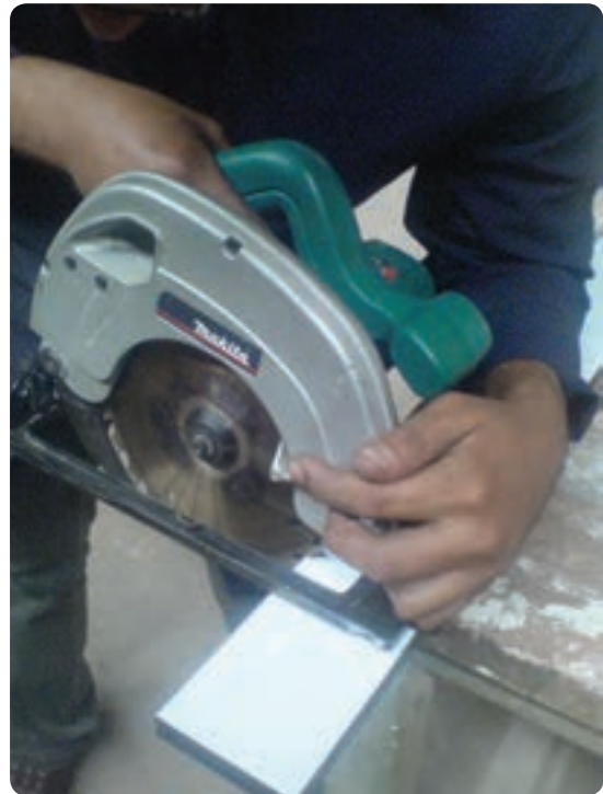
شکل ۲-۲۸ بیانگر رعایت نکردن اصول ایمنی در برش قطعه کار بدون بکارگیری گونیا یا بر راستی است
