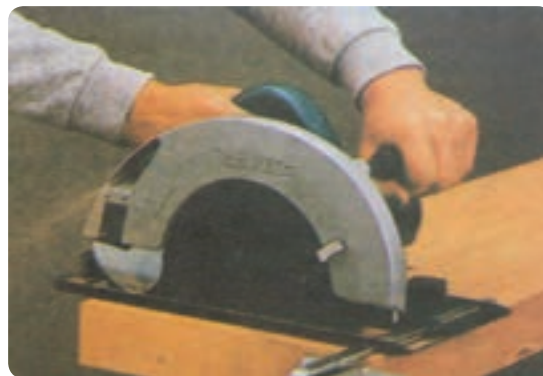
شکل ۳۶-۲ برش به وسیله گونیای دستگاه
