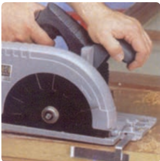
شکل ۲۰-۲ بکارگیری اره گرد دستی برقی
