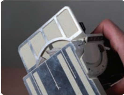
شکل ۲-۹۴ اتصال زن بیسکویتی بدون گونیا
