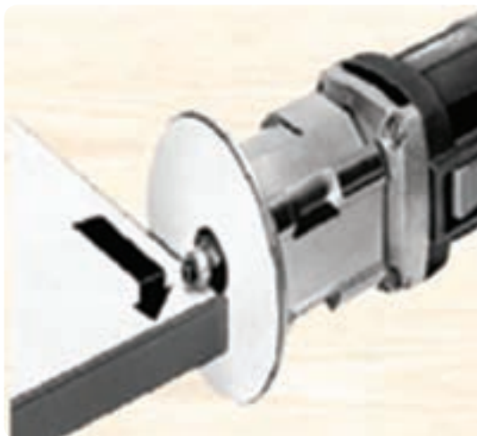
شکل ۱۵۵-۲ پرداخت لبه‌های اضافی روکش مصنوعی
