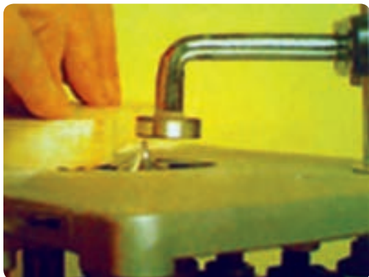
شکل ۲-۶۵ بلبرینگ هدایت برای قطعات قوس‌دار
