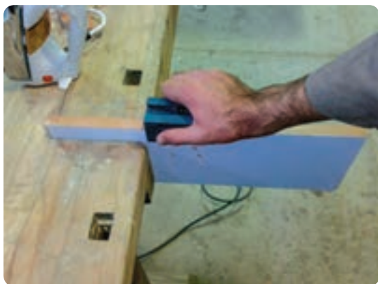
شکل ۱۵۶-۲ رنده پرداخت لبه نوار روکش لبه چسبان
