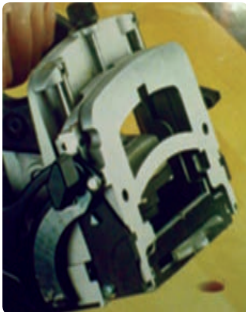
شکل ۲-۹۲ نشان دهنده موقعیت تیغه روی دستگاه
