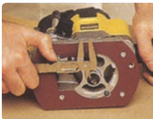
شکل ۶۸-۲ اندازه‌گیری قطر شفت فرز
