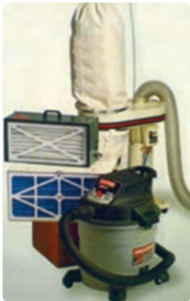
شکل ۷۰-۲ نمونه‌ای از مکنده‌های کارگاهی
