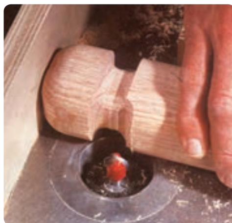
شکل ۲-۶۴ فرز زدن گلوبی یک پایه
