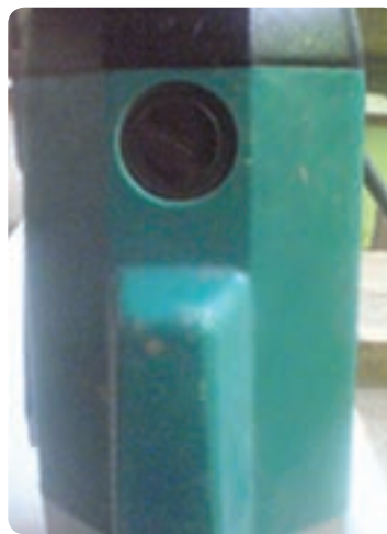
شکل ۶۷-۲ محفظه قرارگیری زغال کلکتور
