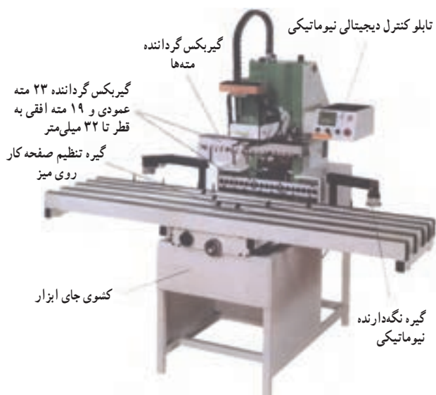
ماشین سوراخ‌زنی و لولازنی دیجیتال نیوماتیک
