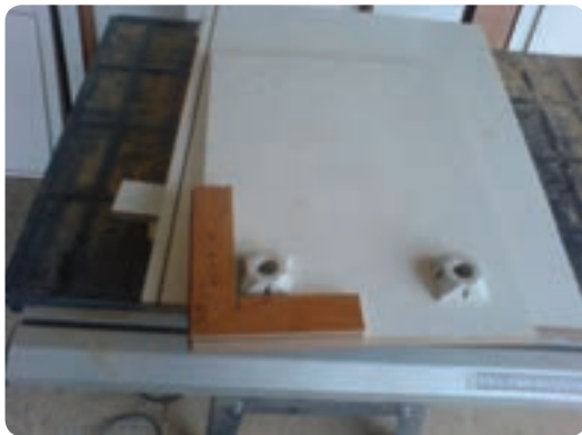
شکل ۶-۱۱۴ شابلون گونیايي جهت نصب پایه کابینت
