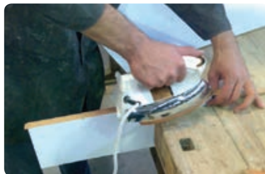
شکل ۶-۸۱ لبه چسبانی روکش مصنوعی با اتو
