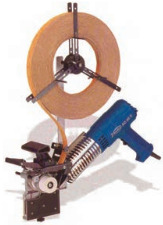
شکل ۱۲۷-۶ سشوار حرارتی برای نوار لب چسبانی صفحات
