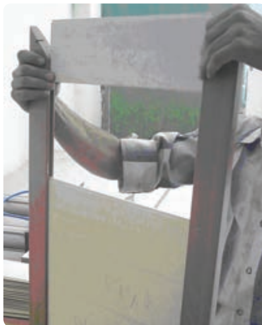
شکل ۶-۹۵ مونتاژ در قابدار با تنگ لته‌ای
