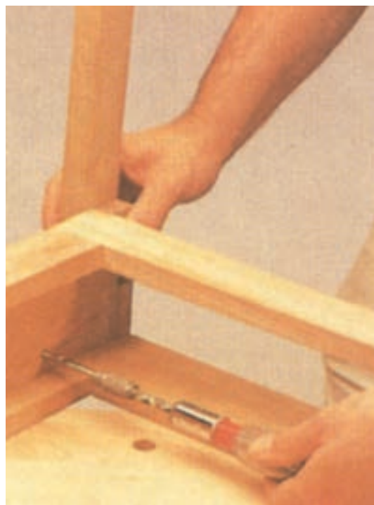
شکل ۶-۱۵۹ اتصال قاب دراور به قاب کناری
