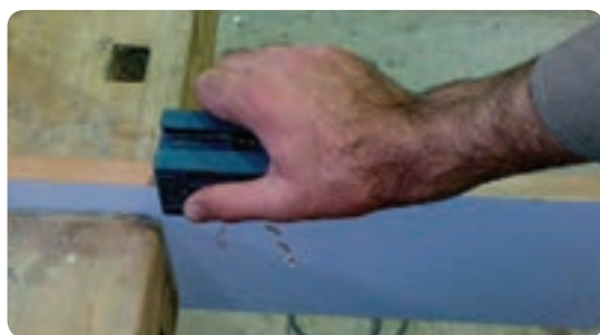
شکل ۶-۸۲ پرداخت لبه اضافی روکش
