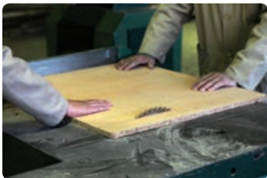
شکل ۶-۷۷ برش در ساده کابینت
