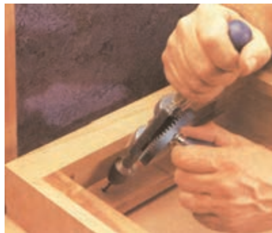
شکل ۶-۱۶۱ مونتاز صفحه میز به قاب دراور
