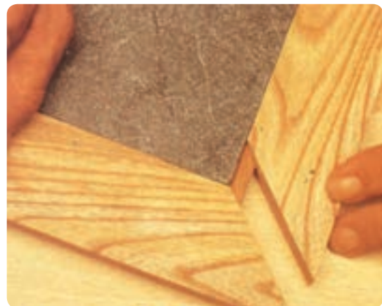
شکل ۶-۱۵۲ مونتاژ صفحه میز
