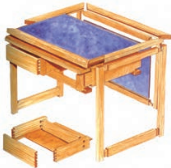
شکل ۶-۱۴۷ تصویر مجسم انفجاری مونتاژ
