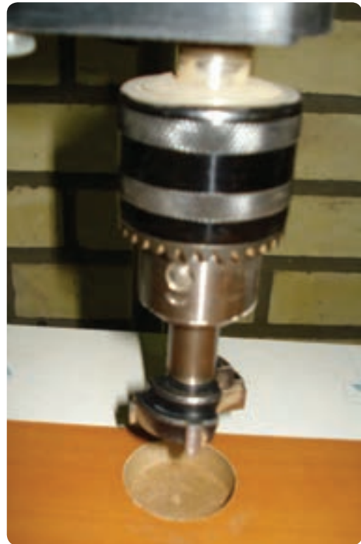
شکل ۶-۷۱ مته کابینت جهت سوراخ کردن جای لولا
