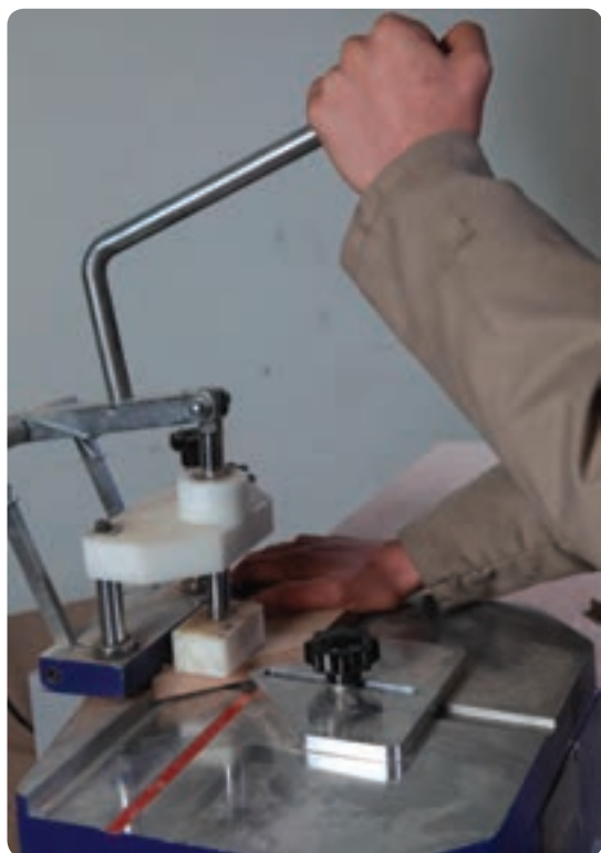
شکل ۹۳-۶ اتصال دم چلچله زن پروفیل
