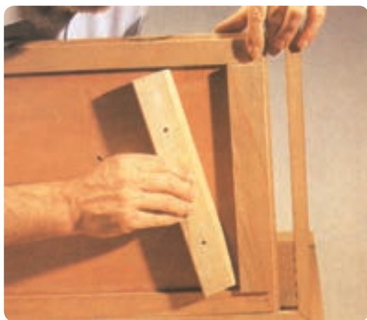
شکل ۱۴۴-۶ اتصال قید کمکی جهت نصب روی دیوار
