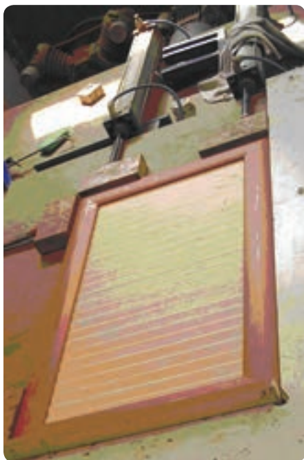
شکل ۶-۹۷ تنگ نیوماتیکی جهت مونتاژ در قابدار کابینت
