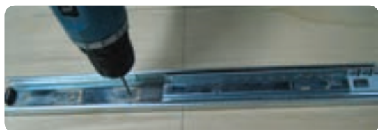
شکل ۷-۳۳ سوراخ‌کاری محل استقرار ریل روی بدنه فایل
