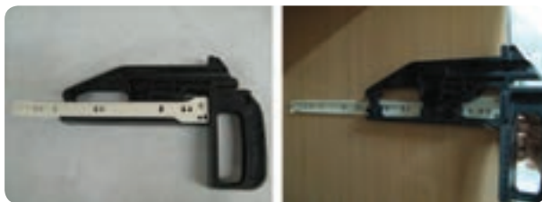
شکل ۲۷-۷ گونبای مخصوص نصب ریل
