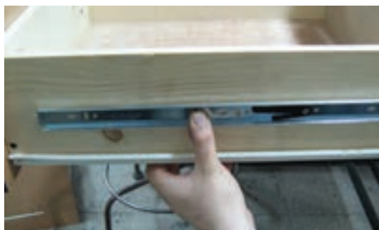
شکل ۷-۳۵ تعیین محل ریل بر روی بدنه کشو
