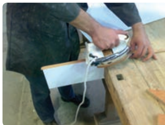
شکل ۱۴۷-۲ اتوکشی نوار روکش لبه چسبان
