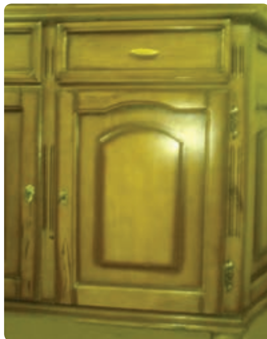
شکل ۶-۲۰ در قاب تنگه‌ای رونشسته دو راهه‌دار
