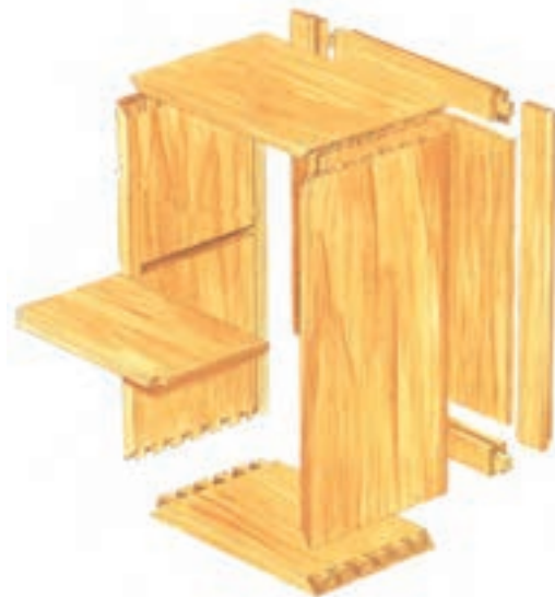
شکل ۶-۱۳۳ پرسپکتیو انفجاری کابینت
