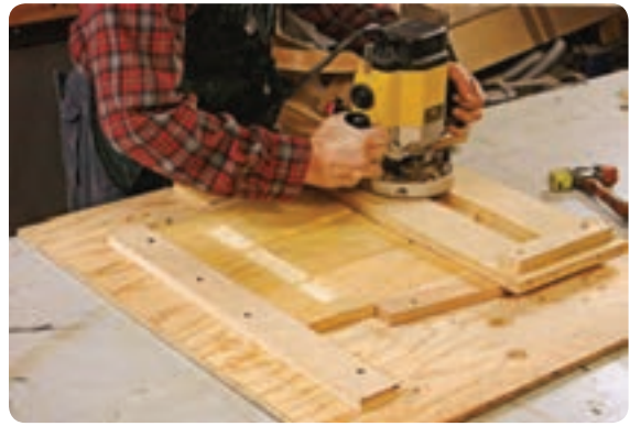
شکل ۳-۲۹ شابلون تسریع کننده و حفاظتی اورفرز
