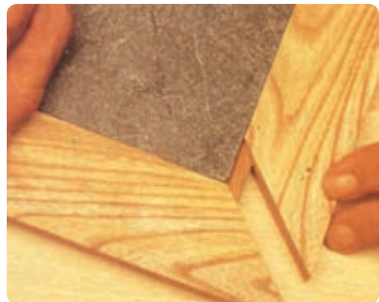
شکل ۶-۱۵۲ مونتاژ صفحه میز
