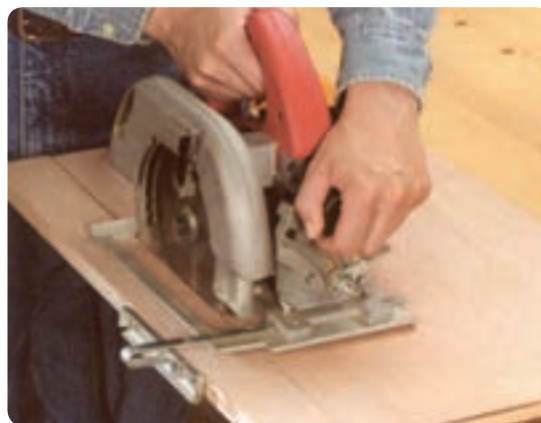
شکل ۲-۲۲ برش عرضی با گونیای ماشین
