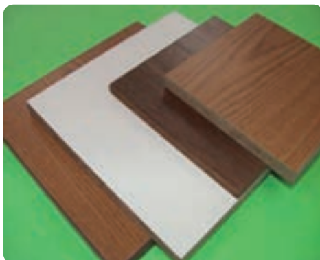
شکل ۱-۲۵ تخته خرده‌چوب روکش شده با پی‌وی‌سی
