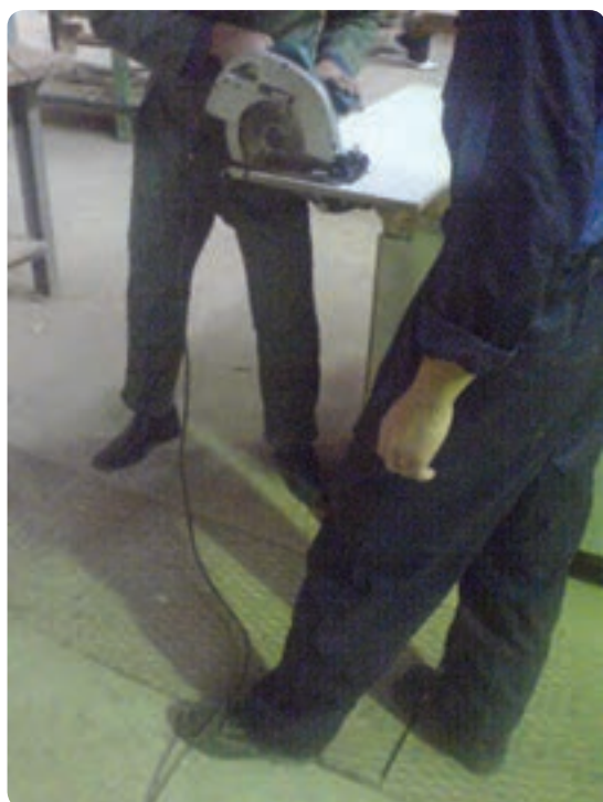
شکل ۲۷-۲ سیم سیار در مسیر نباشد
