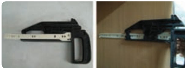
شکل ۲۷-۷ گونبای مخصوص نصب ریل
