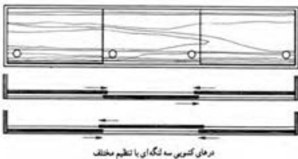
شکل ۶-۲۷ درهای کشویی سه لنگه‌ای با تنظیم مختلف
