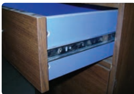
شکل ۵۶-۶ ریل مکانیکی نصب شده در بدنه جعبه
