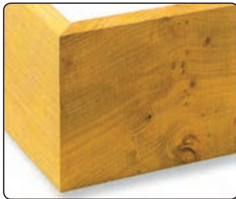
شکل ۴-۱۲۶ اتصال دم چلچله دورو مخفی
