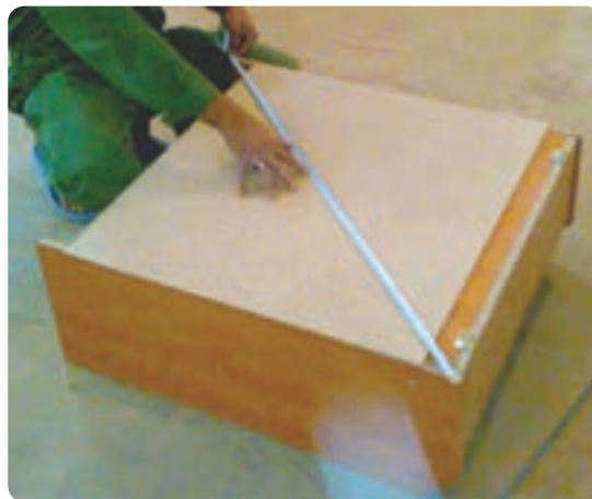
شکل ۶-۱۳۰ کنترل دویدگی کابینت
