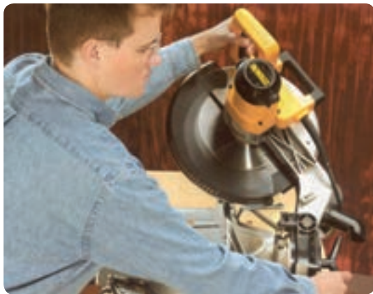
شکل ۹-۲ تنظیم زاویه چرخش اره گرد
