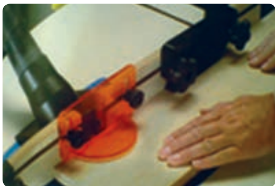
شکل ۲-۷۵ رعایت حفاظت ایمنی در فرزکاری
