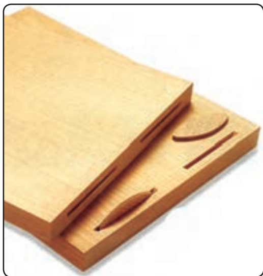
شکل ۸۲-۲ اتصال بیسکویتی دوتایی
