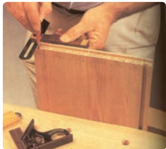
شکل ۶-۱۳۶ خط‌کشی اتصال دم‌چلچله دورو مخفی
