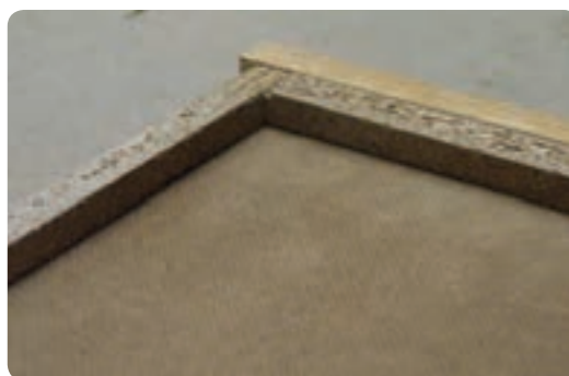
شکل ۶-۱۰۳ کف جعبه در کنشکاف بدنه جعبه و در جعبه
