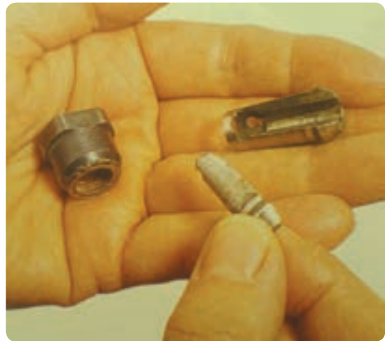
شکل ۲-۴۱ بوش تیغه اور فرز همراه با مهره سفت‌کننده تیغه روی شفت دستگاه
