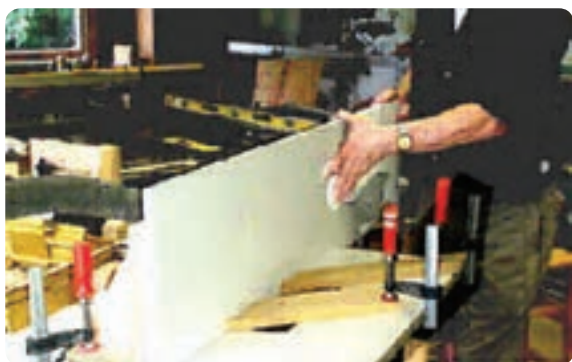
شکل ۳-۲۷ شانه‌های حفاظتی به صورت افقی
