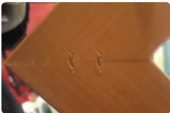
شکل ۹۴-۶ اتصال دوخت قاب
