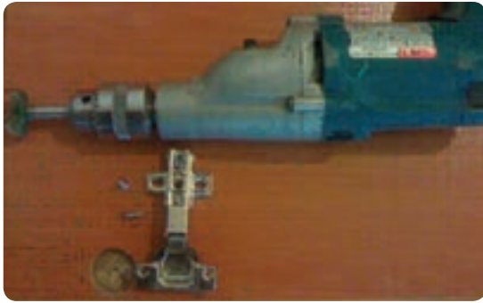
شکل ۱۲۸-۶ نصب لولای کابینت فردار روی در کابینت
