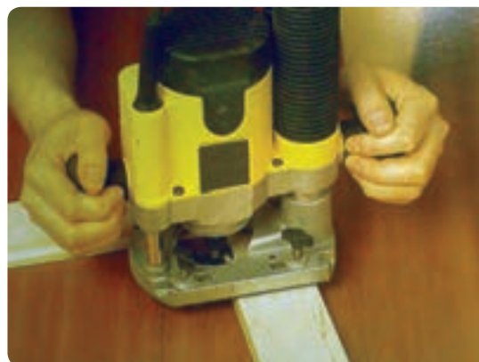
شکل ۵۹-۲ فرز کاری داخل قاب
