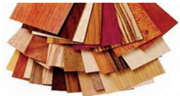
شکل ۱۹-۱ انواع روکش‌های طبیعی
