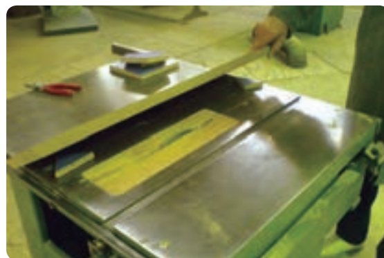
شکل ۳-۳۹ قراردادن دو عدد زیرسری برای ساخت گونیا
