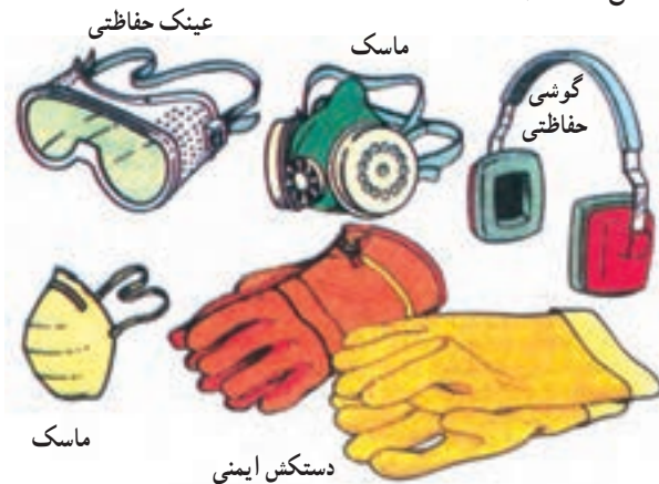
شکل ۳۸-۲ استفاده از وسایل حفاظتی
