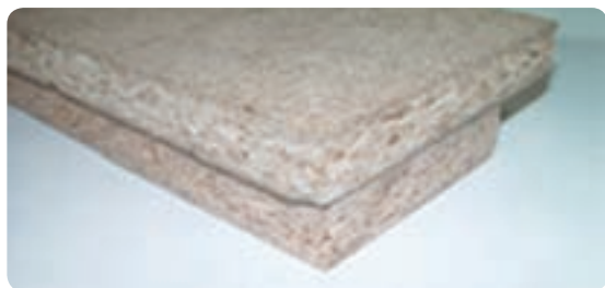
شکل ۳۴-۱ تخته بدون لایه مشخص
