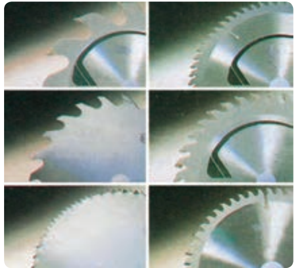
شکل ۳۵-۲ چند نمونه از تیغه های گرد (مجموعه ای) جهت برش مواد چوبی و غیر چوبی
