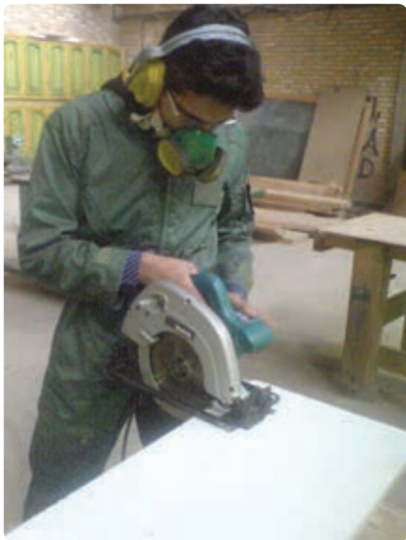
شکل ۲-۳۰ تجهیزات حفاظت فردی به هنگام کار
