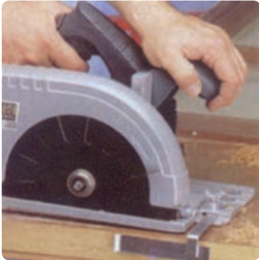
شکل ۲۰-۲ بکارگیری اره گرد دستی برقی
