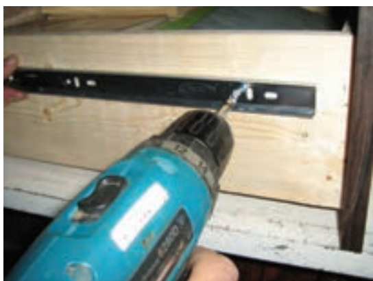
شکل ۷-۳۶ نصب ریل بر روی بدنه‌ی کشو
