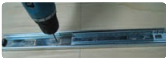
شکل ۷-۳۳ سوراخ‌کاری محل استقرار ریل روی بدنه فایل
