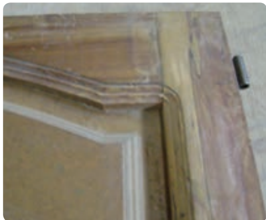
شکل ۶-۸۹ ابزار زدن قاب و تنکه
