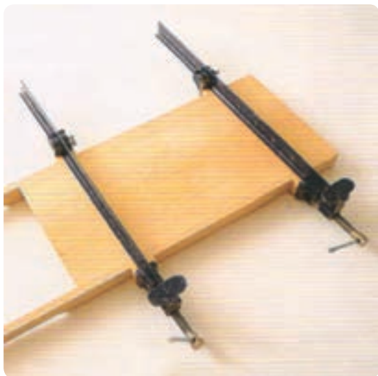
شکل ۵۹-۸ موتناژ بدنه به پایه
