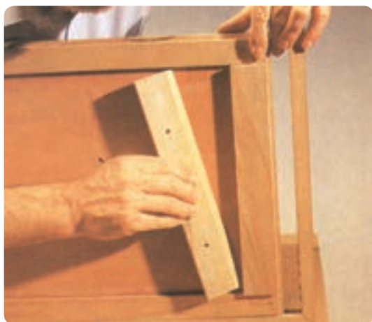
شکل ۱۴۴-۶ اتصال قید کمکی جهت نصب روی دیوار
