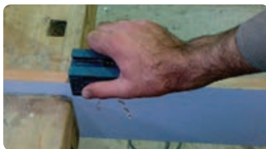
شکل ۶-۸۲ پرداخت لبه اضافی روکش
