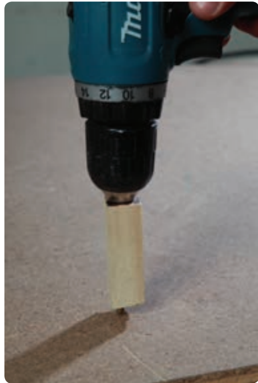
شکل ۳-۳۲ سوراخ دریل قطعه کنترل اندازه عمق
