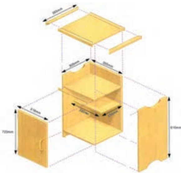
شکل ۳۵-۸ نقشه مونتاز قطعات کابینت
