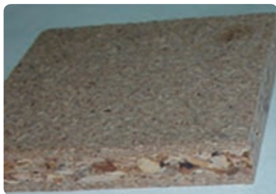
شکل ۳۳-۱ تخته خرده چوب سه لایه
