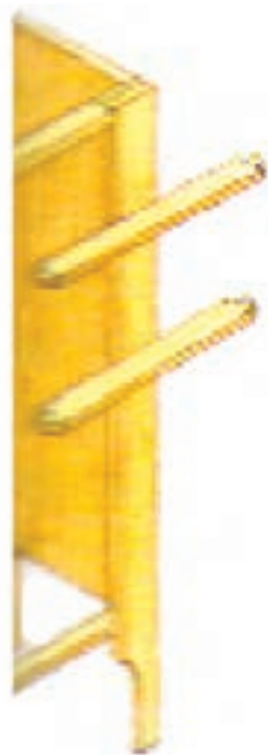
شکل ۶۳-۸ موقعیت قیدهای عرضی داخلی در کابینت پایه‌دار
