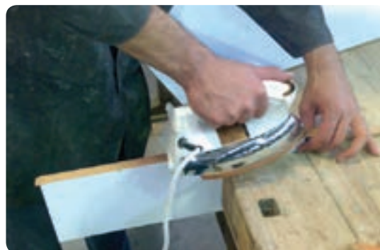
شکل ۶-۸۱ لبه چسبانی روکش مصنوعی با اتو
