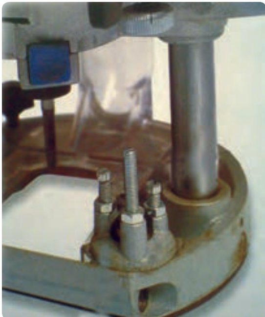
شکل ۲-۴۴ پیچ‌های تنظیم ارتفاع اور فرز دستی برقی
