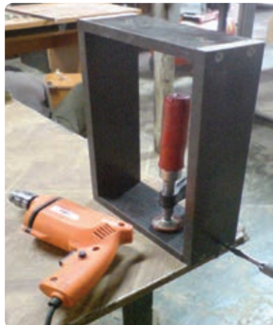
شکل ۶-۱۰۸ مونتاژ دستی جعبه کشو
