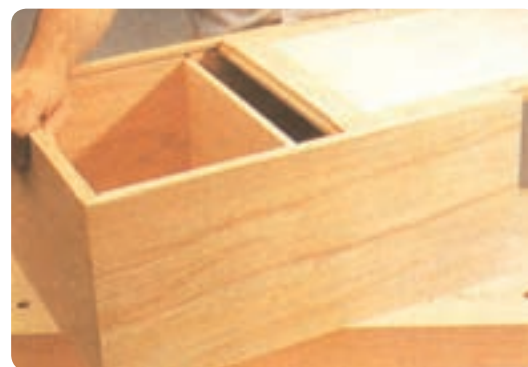
شکل ۱۴۳-۶ قرارگیری پشت بند در کنشکاف بدنه کابینت
