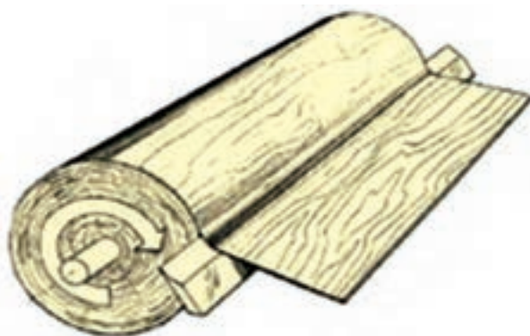
شکل ۱-۲۰ تهیه روکش به روش لوله‌بری
