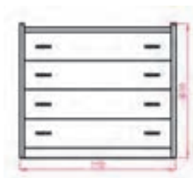
نمای کابینت دراور ۴ کشو، بدون پاستنگ (عمق ۳۵۰)
