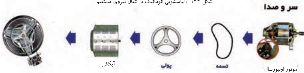
شکل ۱-۱۴۵-الباسشویی اتوماتیک با انتقال نیروی غیرمستقیم
