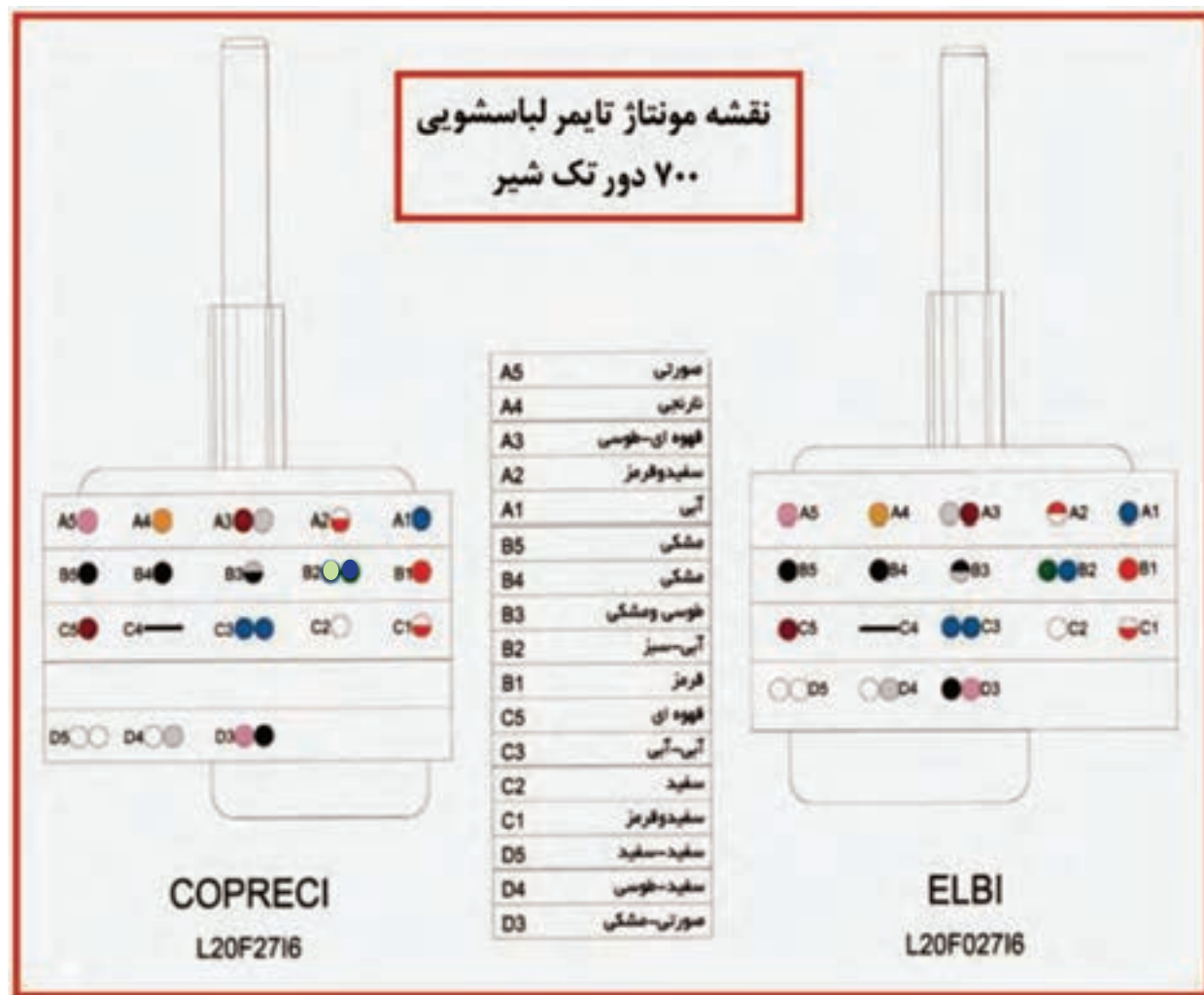
شکل ۱-۱۶۵- نقشه مونتاژ تایمر لباسشویی ۷۰۰ دور تک شیر
