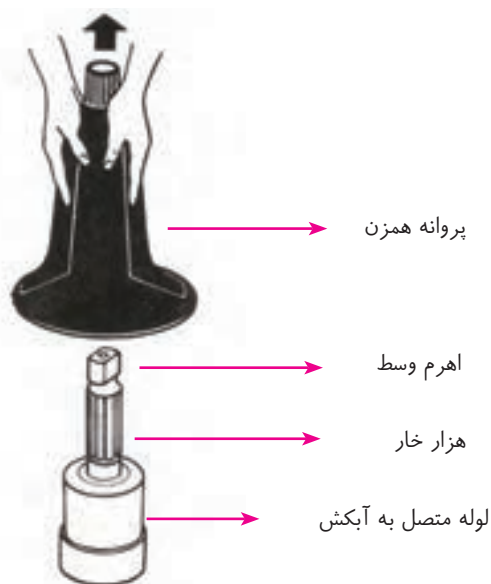
شکل ۱۰۳-۱ نحوه بیرون آوردن پروانه همزن
