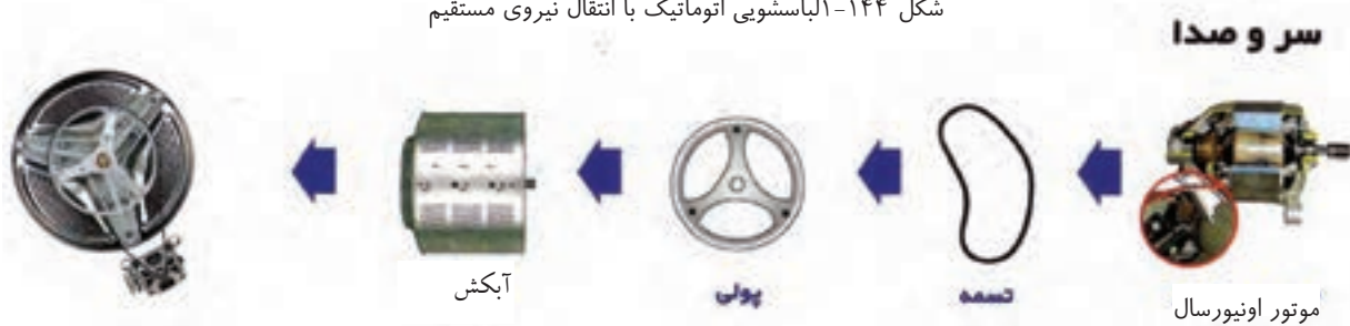
شکل ۱-۱۴۵-الباسشویی اتوماتیک با انتقال نیروی غیرمستقیم
