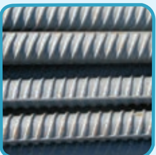
شکل ۱۷-۱- میلگرد با رویه آجدار
