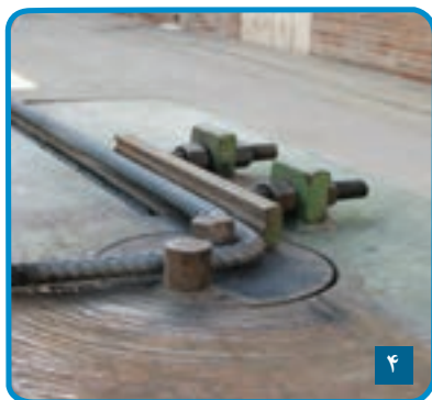
شکل ۶۴-۳- خم کردن میلگرد
