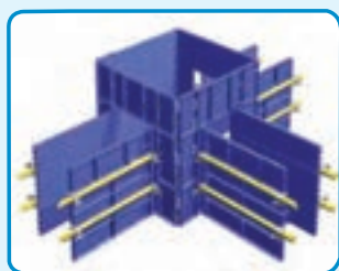
شکل ۳-۲۸- قالب فلزی برای اجرای پی
