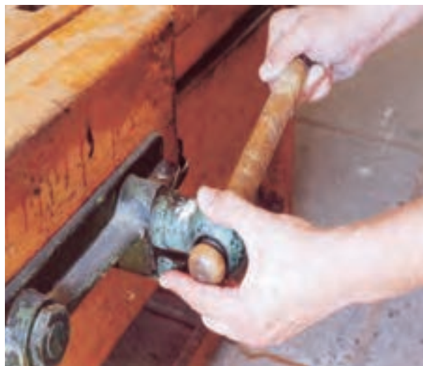
شکل ۲-۱۸- ضامن باز و بسته کردن آزاد گیره.
