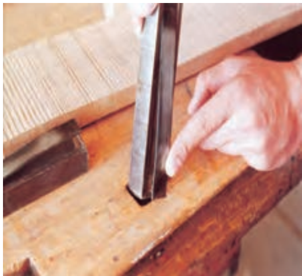
شکل ۲-۲۰- نمونه‌ی استقرار آهن نگهدارنده‌ی قطعه کار.
