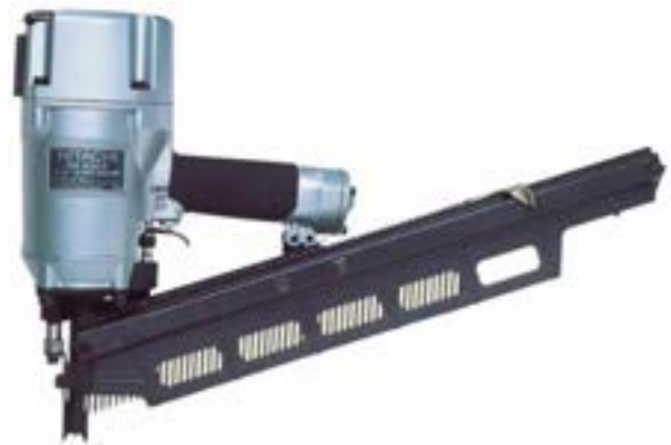
شکل ۸-۱۸- میخ‌کوب، برای اتصال پوچ‌های ضمیمه.
