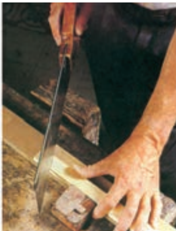
شکل ۱۱-۱۰- برش زهوار، با زاویه‌ی ۴۵ درجه.
