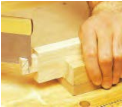
شکل ۹۹- به اندازه (ساختن زبانه با اره‌ی ظریف‌بُر (پشت‌دار).
