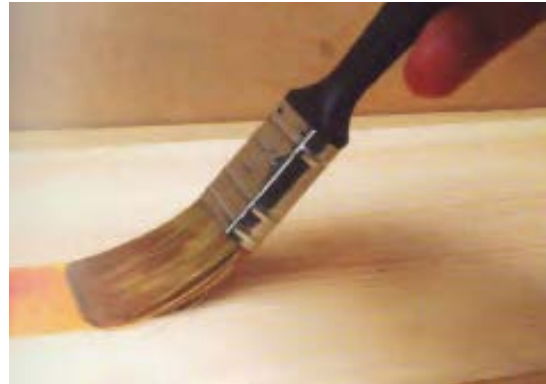
شکل ۴-۴۳- قلم‌مو را در جهت الیاف چوب بکشید.
