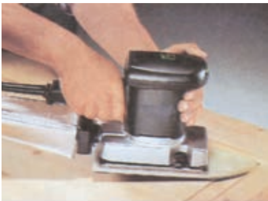
شکل ۴۷-۷- سنباده کاری گوشه‌های تیز داخلی با دستگاه سنباده کف مثلثی.
