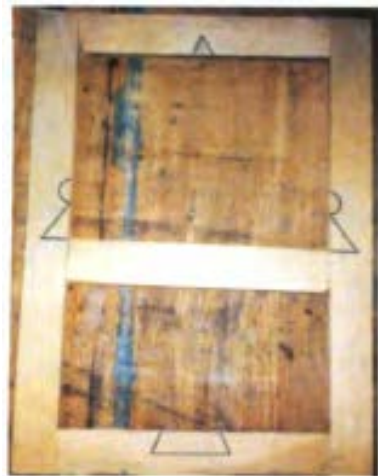
شکل ۱-۱۳- کاربرد علائم در هنگام مونتاژ. به علامت‌های قراردادی توجه کنید.
