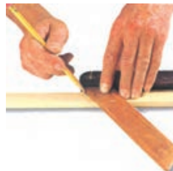
شکل ۱۰-۱۰- فطاکشی زهوار، با زاویه‌ی ۴۵ درجه.
