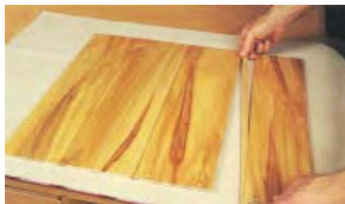
شکل ۵-۲۶- جور کردن (روکش‌ها)
