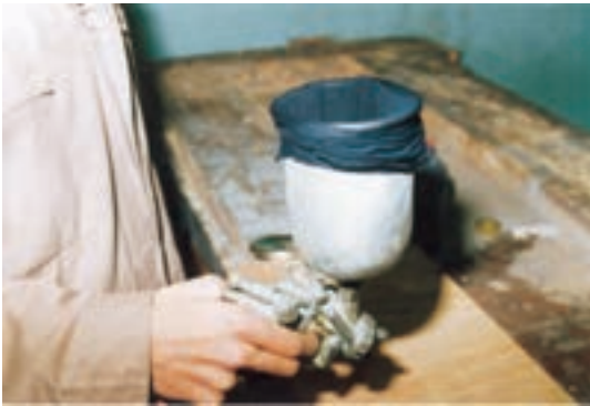
شکل ۴-۴۵- رنگ را از صافی عبور داده و ماشه‌ی پیستوله را چند بار فشار دهید.
