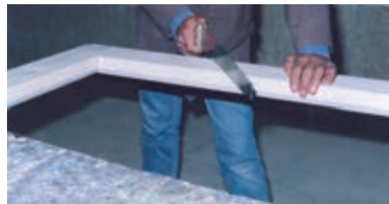
شکل ۱۱-۲۶- ایجاد شیار با اراهی دستی.
