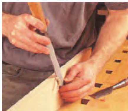
شکل ۵-۳۷- با سوهان نرم می‌توان لبه‌ی اضافی روکش را برطرف کرد.
