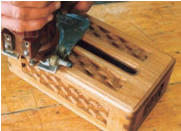
شکل ۹-۷۱- فرز کاری لبه‌های کار و شیار محل خروج دستمال کاغذی.
