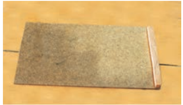
شکل ۹-۶۲- پسباندن زهوار به لبه‌ی کف جعبه.
