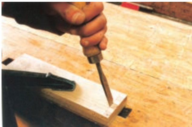
شکل ۹-۶۶- فالی کردن ممل فاق و زبانه با مغار و چکش چوبی.
