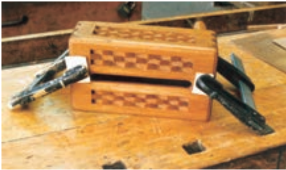
شکل ۹-۷۰- بستن سقف به بدنه‌ها.
