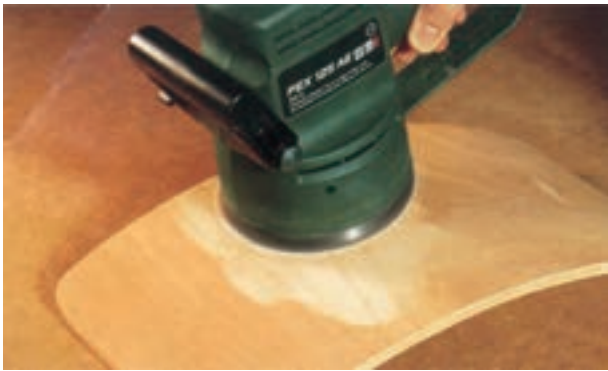
شکل ۲۷-۷. هنگام تعویض ورق سنباده باید دو شاخه دستگاه را از پریز فارج کنید.
