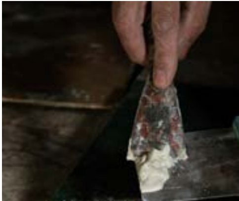
شکل ۱۸-۴. با کشیدن لیسه و کاردک به هم، باید آنها را تمیز کرد.
