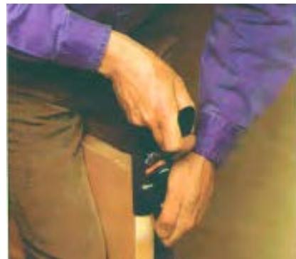
شکل ۲-۲۱- برای رندیدن سر چوب، رنده از خارج به داخل هدایت می‌شود.
