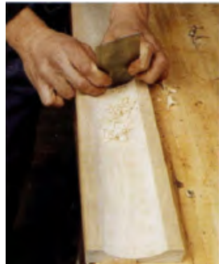
شکل ۵-۲- کاربرد لیسه با لبه‌ی نیمه گرد.
