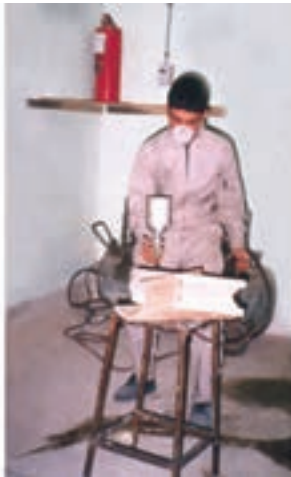
شکل ۴-۳۷- هنگام رنگ کاری، از ماسک و وسایل حفاظت ایمنی فردی لازم استفاده کنید.
