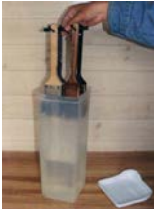
شکل ۴-۴۱- قلم‌موها را پس از تمیز شدن، داخل قوطی مایه نفت یا تینر قرار دهید.
