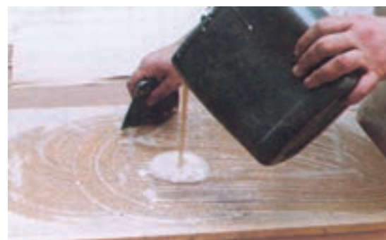
شکل ۴-۶- پفش کردن چسب به وسیله‌ی شانه‌ی چسب‌زنی.
