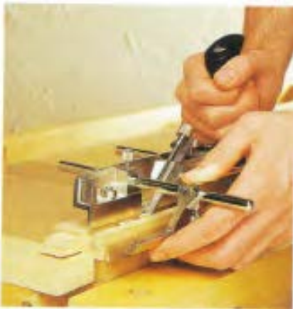
شکل ۱۰۰- شیار انداختن داخل قیده‌های عرضی.
