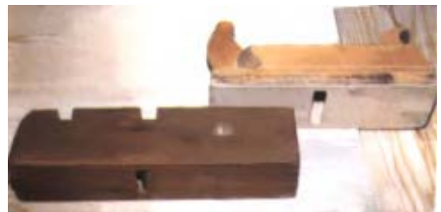
شکل ۲-۱۷- پس از پایان کار، رنده‌ها به پهلو فوابانده شود.
