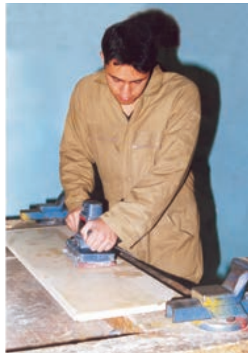
شکل ۷-۱۰. پیچونگی کنترل دستگاه سنباده لرزان.
