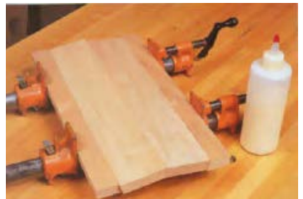
شکل ۱۴۵- هنگام چسباندن تخته‌های درز شده به وسیله‌ی تنگ، نباید فشار تنگ، بیش از حد باشد، زیرا تخته‌ها قوس بر می‌دارد.
