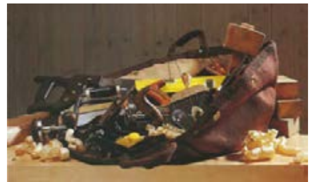
شکل ۲-۱۶- ریفتن ابزارها (روی هم، علاوه بر کاهش تیزی، از دقت آنها نیز می‌کاهد.
