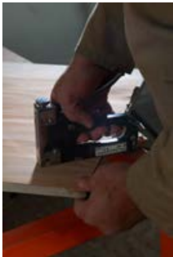
شکل ۶-۱۸- روکش را به کمک منگنه روی صفحه ثابت کنید.
