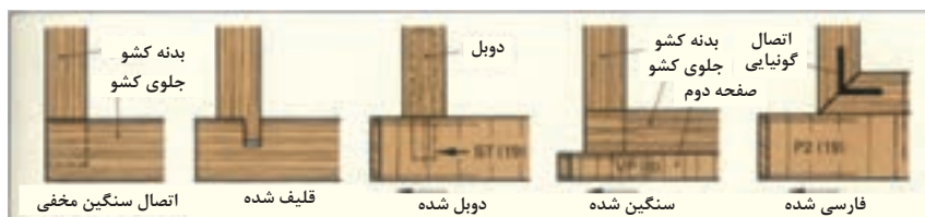
شکل ۱۴- انواع اتصالات برای صفحه جلوی کشو
