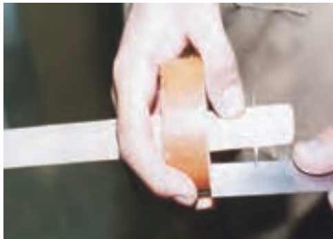
شکل ۸-۳- تنظیم خط کش تیره‌دار، به کمک خط کش فلزی.
