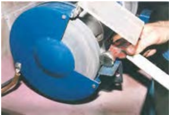
شکل ۷-۴۰- گرفتن پلیسه به وسیله‌ی سنگ سنباده.
