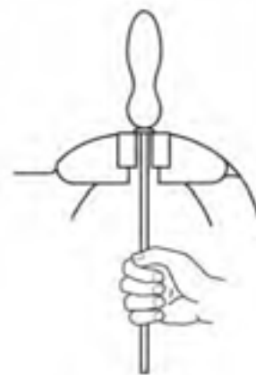
شکل ۱۱-۲۱- روش درآوردن سوهان از دسته.
