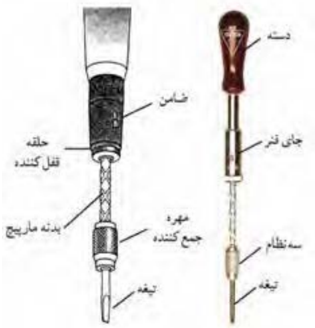
شکل ۱۲-۷. قسمت‌های مختلف یک دریل فشاری.
