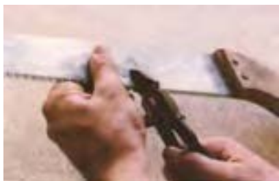
شکل ۱۴-۵۴-۱. فم کردن بقیه دندانها به طرف پایین.
