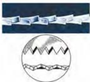
شکل ۱۷-۱۴. دندانه‌های چپ و راست شده.
