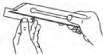
شکل ۱۴-۴۱. آزمایش تیزی تیغه رنده.
