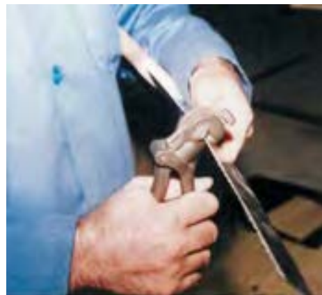
شکل ۱۴-۵۳-۱. چپ و راست کردن دندان بدون استفاده از تنگ.
