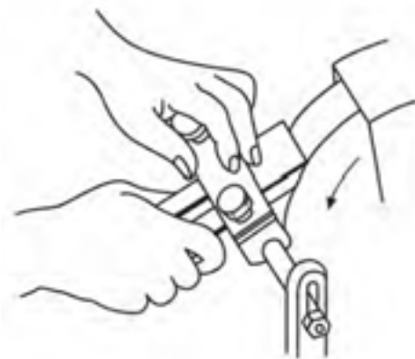
شکل ۱۴-۲۴- تیزکردن تیغه رنده با سنگ سنباده.
