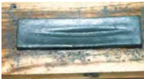
شکل ۴-۱۴- استفاده‌ی نادرست از سنگ نفت.
