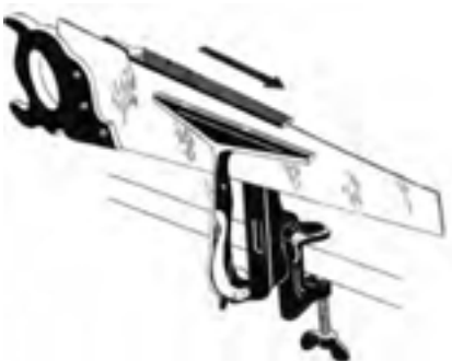
شکل ۱۴-۶۲- میزان کردن دندان‌های اره به وسیله سوهان.
