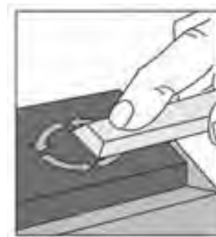
شکل ۱۴-۴۹- پلیسه‌گیری تیغه با سنگ نفت.
