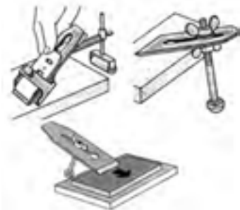
شکل ۱۴-۴۲. استفاده از وسایل کمکی برای استقرار بهتر تیغه روی سنگ نفت.
