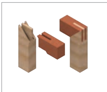
۸- اتصال گوشه‌ای فاق و زبانه دو تایی دو رو فارسی.
