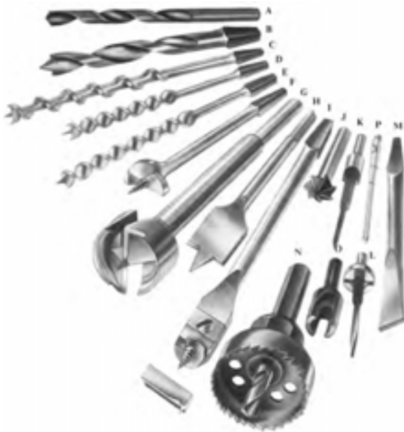
شکل ۱۱-۱۲- انواعی از سر مته‌های مخصوص چوب.
