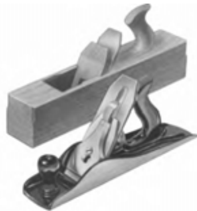
شکل ۶-۵۴- نمونه‌هایی از رنده چوبی و فلزی.
