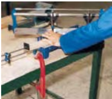
شکل ۵-۶۴- ایجاد برش ۴۵ درجه به وسیله‌ی اژه فارسی‌بُر.
