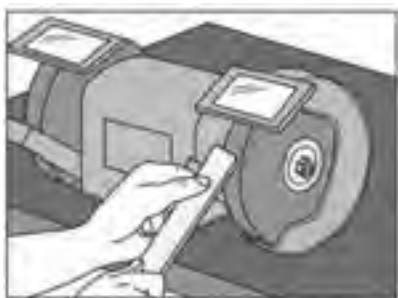
شکل ۱۴-۴۵ قرار دادن تیغه روی تکیه‌گاه.
