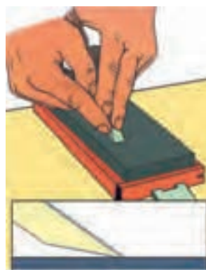
شکل ۱۴-۳۳- نمونه‌ی قرار دادن صمیع تیغه (روی سنگ) (زاویه‌ی تیغه).
