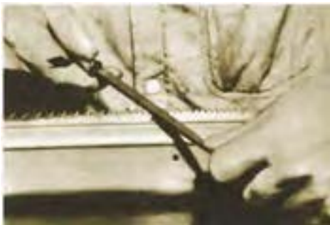
شکل ۱۴-۲۲- تیزکردن اره با استفاده از سوهان.
