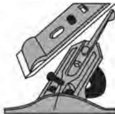
شکل ۶-۱۸- قرار دادن تیغه و پشتی، در داخل کوله.
