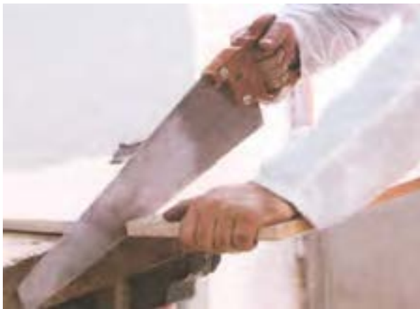
شکل ۵-۸- نمونه‌ی برش به وسیله ارّه دُم روباهی.
