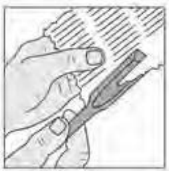
شکل ۱۴-۳۶- آزمایش تیزی مغار.
