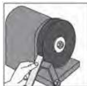
شکل ۱۴-۴۴ تنظیم تکیه‌گاه سنگ سنباده.
