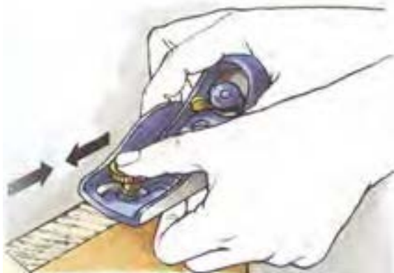
شکل ۶-۶۰- رنده کله چوب و نحوه‌ی استقرار آن روی چوب.
