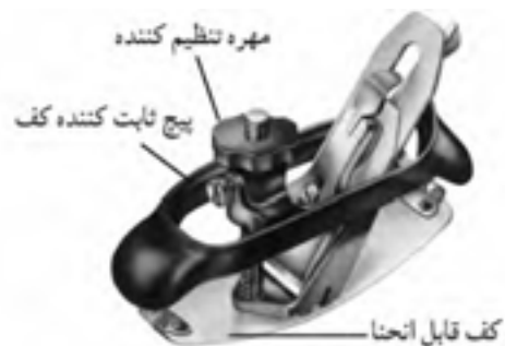
شکل ۶-۴۶- قسمت‌های مختلف رنده کاس و سینه.
