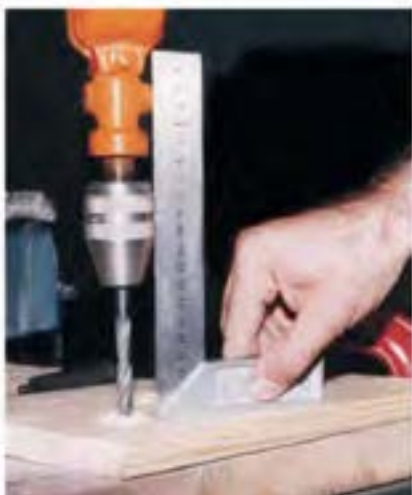
شکل ۱۲-۴۷- آزمایش گونمایی قرار گرفتن دریل.
