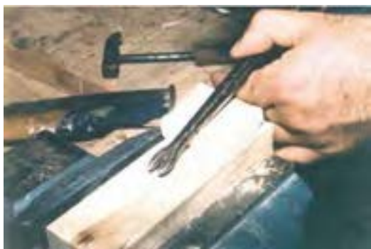
شکل ۷-۳۵- استفاده از دسته‌ی گاز انبر برای درآوردن میخ.
