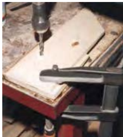
شکل ۵-۵۸- ایجاد سوراخ در قسمت داخلی قطعه کار.
