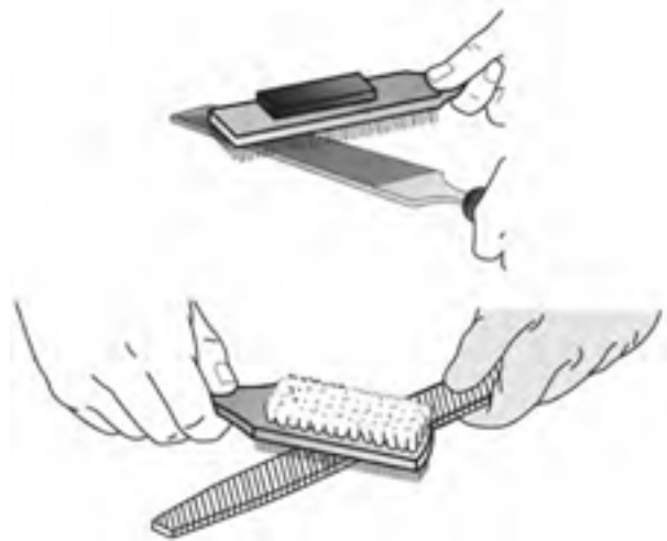
شکل ۱۱-۲۹- تمیز کردن سوهان با برس.
