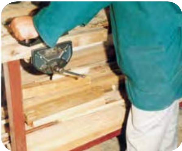
شکل ۶-۷۳- نمونه‌ی ایستادن هنگام رنده‌کاری.
