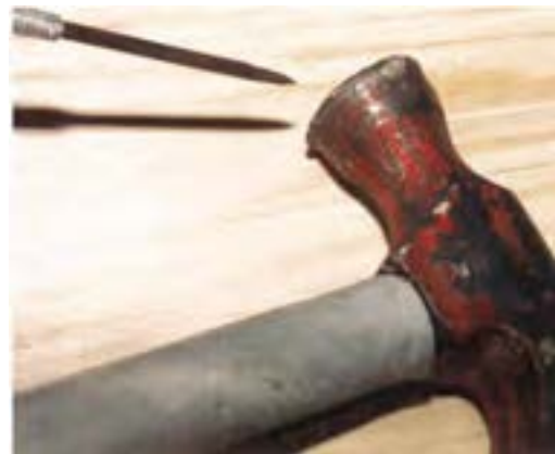
شکل ۷-۳۹- پلیسه‌ی ایجاد شده در سر چکش.
