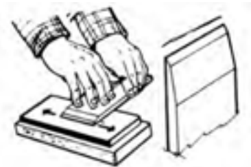
شکل ۱۴-۴۰. پلیسه‌گیری تیغه رنده.
