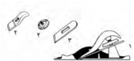
شکل ۶-۶۱- قسمت‌های تفکیک شده رنده کله چوب شامل:
