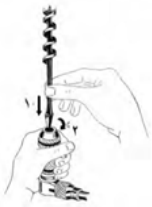
شکل ۱۲-۳۵- بستن سر مته به دریل.
