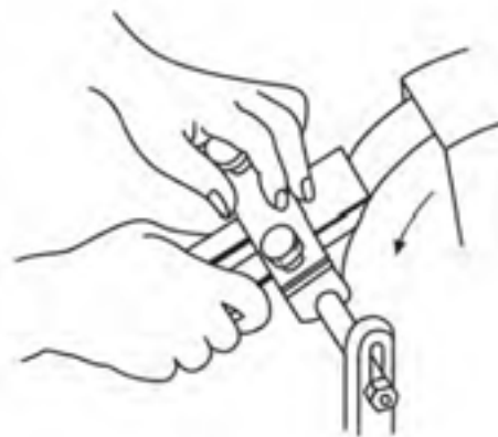
شکل ۱۴-۲۴- تیزکردن تیغه رنده با سنگ سنباده.
