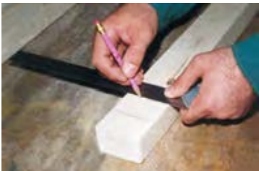
شکل ۵-۴۸- فم‌کشی قطعه کار به‌وسیله‌ی گونیا و مداد.
