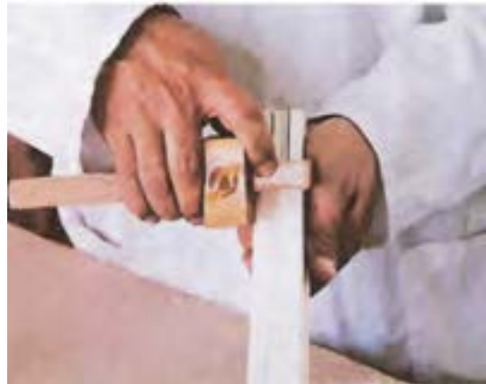
شکل ۵-۵۴. فلکشی با استفاده از فلکش تیزه‌دار.
