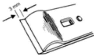
شکل ۶-۷- نمونه‌ی قرار گرفتن پشتی روی تیغه.
