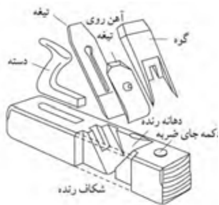
شکل ۱۳-۶. قسمت‌های مختلف اجزای رنده پوچی و نحوه‌ی جاگذاری آنها.
