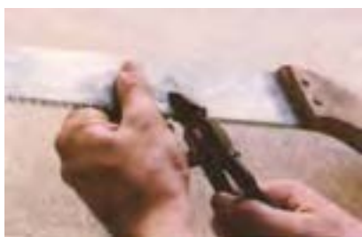
شکل ۱۴-۵۴- فم کردن بقیه دندانها به طرف پایین.
