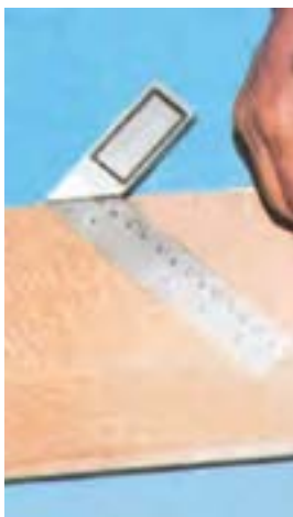
شکل ۶-۱۰۴- خط‌کشی فطوط ۴۵ درجه به وسیله‌ی گونیای معمولی.
