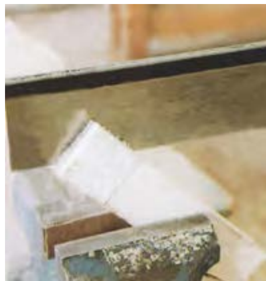
شکل ۵-۵۵. مالت افقی ارّه در پایان برش.
