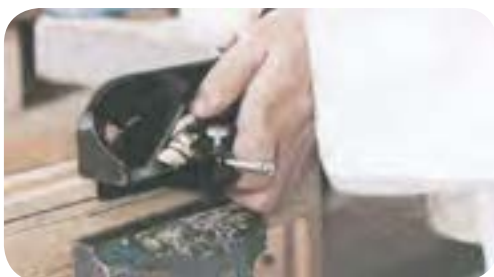
شکل ۶-۷۸. به کارگیری رنده بغل قابل تنظیم.
