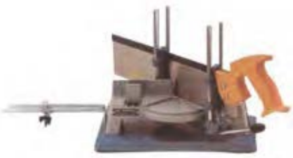
شکل ۵-۱۱- استفاده از اره پشت‌دار به عنوان اره فارسی‌بر.
