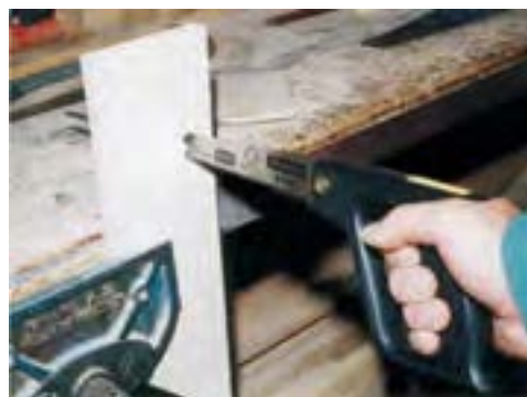
شکل ۵-۵۹- نمونه‌ی ایجاد سوراخ به وسیله‌ی اره نوکی.
