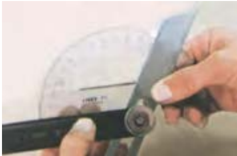
شکل ۱۰۰-۶- استفاده از نقاله در گونیا‌یی تاشو.
