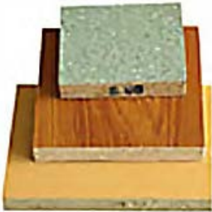
شکل ۳-۱۴۶- تخته فرده چوب با روکش مصنوعی.
