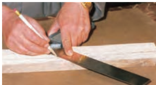
شکل ۶-۹۳- کار کردن با گونیای فارسی.
