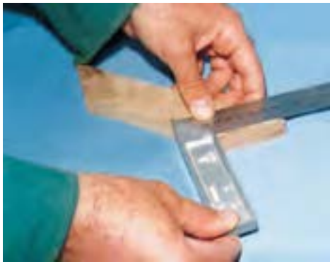
شکل ۵-۶۵- کنترل گونیاپی بودن قطعه کار.
