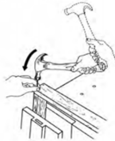
شکل ۲۸-۷. ضربه زدن در راستای محور میخ.
