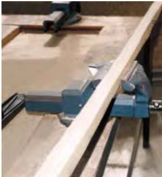
شکل ۸۳-۶. بستن قطعه کار به گیره میز کار.
