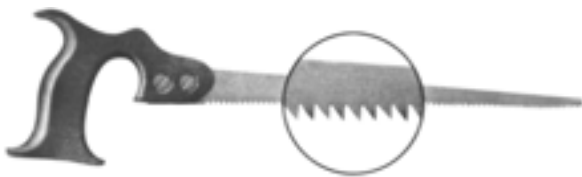
شکل ۵-۱۳- اره نوکی، با بزرگنمایی دندان‌ها.
