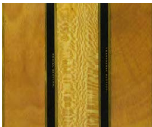
شکل ۳-۱۴. چوب چنار در سه برش عرضی، شعاعی، مماسی.
