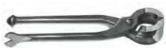
شکل ۷-۴- گاز انبر با دسته‌ی میخ کش.
