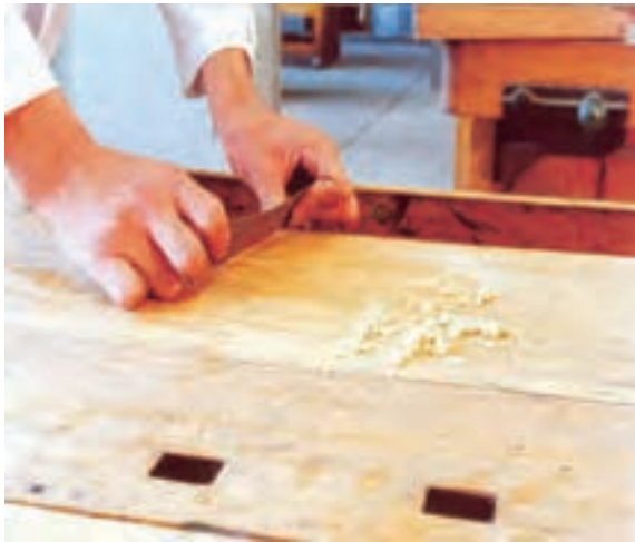
شکل ۱۷-۲- تمیز کردن سطح میز کار با لیسسه.
