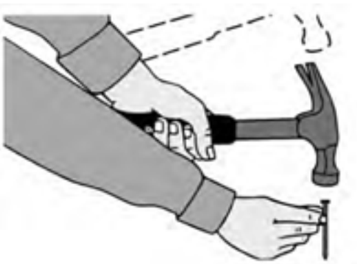
شکل ۳۱-۷. نمونه‌ی گرفتن میخ هنگام کوبیدن.
