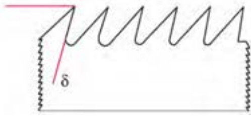
شکل ۵-۳۴- زاویه‌ی برش، کمتر از ۹۰ درجه.
