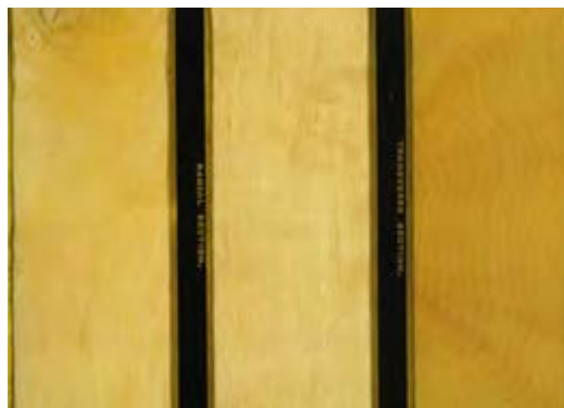
شکل ۳-۲۰- برش‌های عرضی، شعاعی و مماسی چوب ممرز
