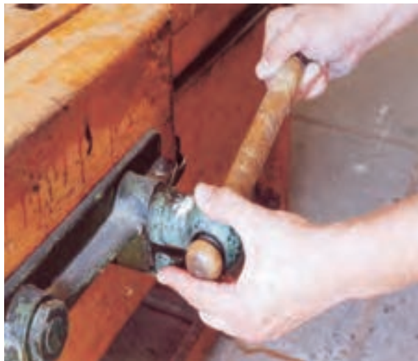
شکل ۲-۱۸- ضامن باز و بسته کردن آزاد گیره.
