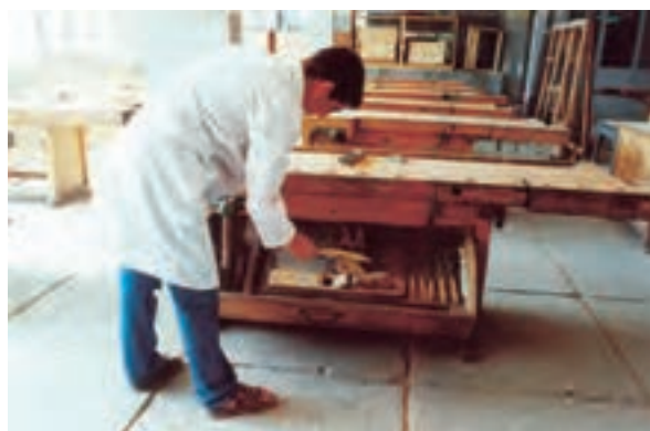
شکل ۲-۱۱- تمیز کردن دافل جمعیه ابزار میز کار.
