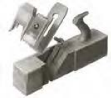
شکل ۱۴-۶. با انداختن تیغه‌ی رنده پوچی.
