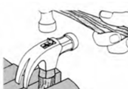
شکل ۷-۲۳- کوبیدن گوه به سر چکش.
