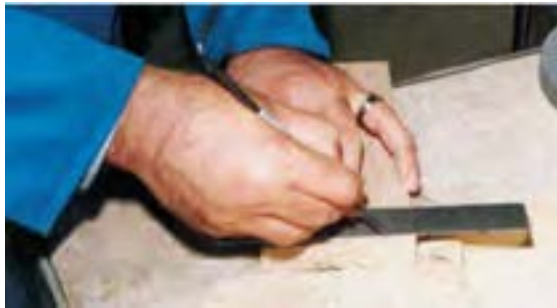
شکل ۶-۸۶- خط‌کشی با استفاده از گونیا.
