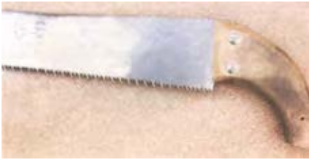
شکل ۵-۳- اژه‌ی دندانه‌رو به عقب.
