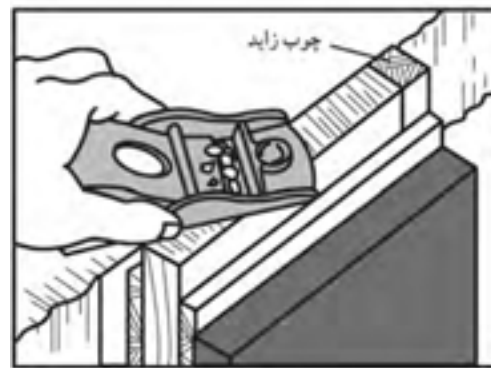
شکل ۶-۸۹- قرار دادن چوب زاید در انتهای قطعه کار.
