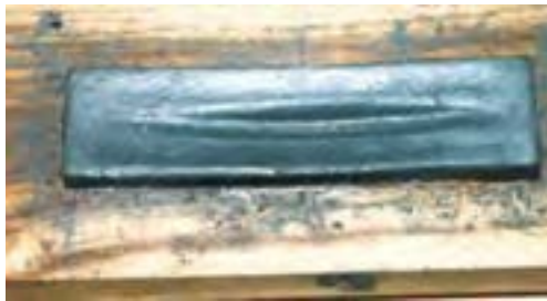
شکل ۴-۱۴- استفاده‌ی نادرست از سنگ نفت.
