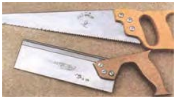
شکل ۵-۲- اژه‌های دندانه‌رو به جلو.
