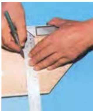
شکل ۶-۱۰۳- استفاده از گونیا برای خط‌کشی.
