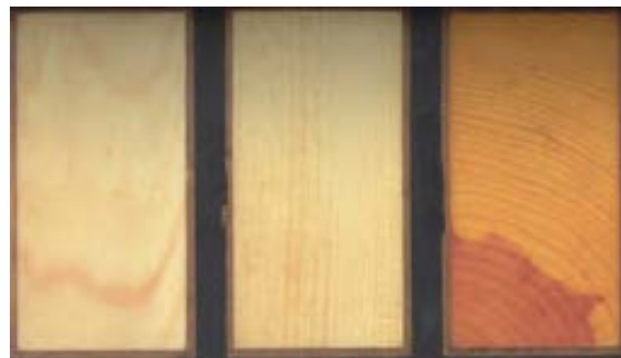
شکل ۳-۲۳ چوب کاج در سه برش عرضی، شعاعی، مماسی.
