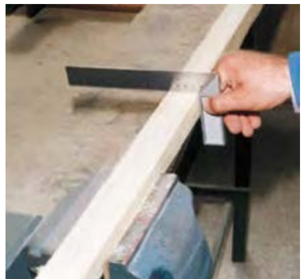
شکل ۶-۸۵- صمت گونیايي بودن قطعه کار با گونیا.
