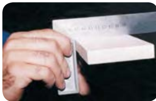
شکل ۶-۷۴. آزمایش صمت رنده‌کاری با گونیا
