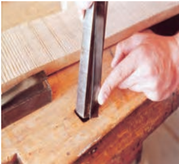
شکل ۲-۲۰- نمونه‌ی استقرار آهن نگهدارنده‌ی قطعه کار.
