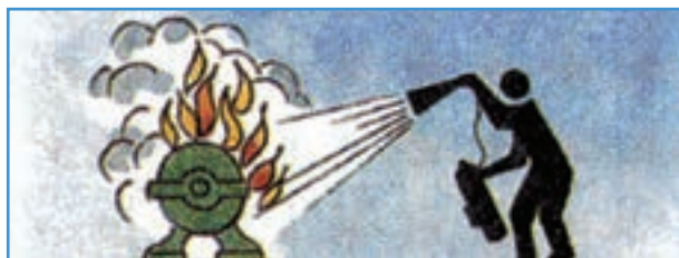
شکل ۱۴-۱- خاموش کردن آتش با دی اکسید کربن
