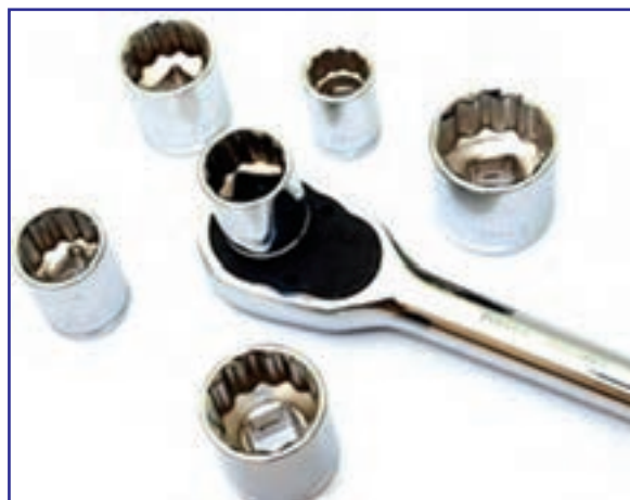
شکل ۴۸-۳- اتصال بکس به دسته بکس جفجغه ای
