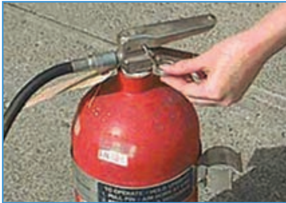
شکل ۱۱-۱- نحوه خارج کردن ضامن کپسول
