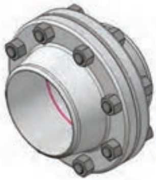
شکل ۳-۱- کاربرد پیچ و مهره برای اتصال
