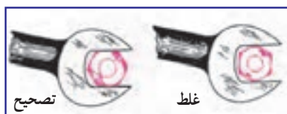
شکل ۲۹-۳ طرز درگیر کردن آچار تخت با مهره
