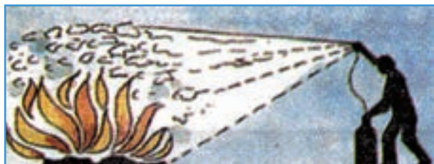
شکل ۱۵-۱- خاموش کردن آتش با کف
