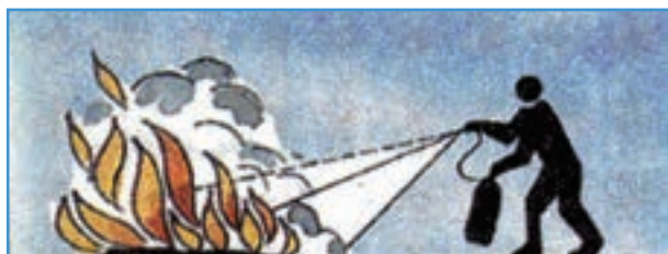
شکل ۱۳-۱- روش خاموش کردن آتش با پودر
