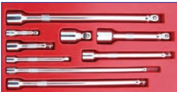
شکل ۴۷-۳- انواع رابط بکس
