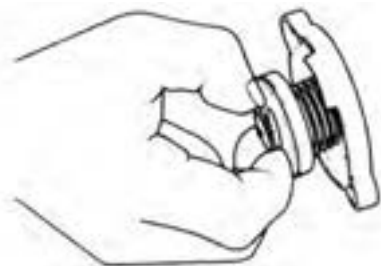
شکل ۱۷-۳- آزمون سوپاپ مکش در رادیاتور
