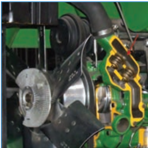
شکل ۲۴-۳ - طرز صحیح قرار گرفتن ترموستات
