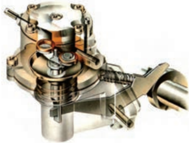
شکل ۷-۴ پمپ مقدماتی دیافراگمی
