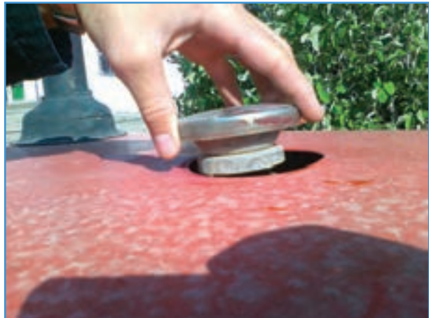
شکل ۷-۳- باز کردن در رادیاتور تراکتور MF285
