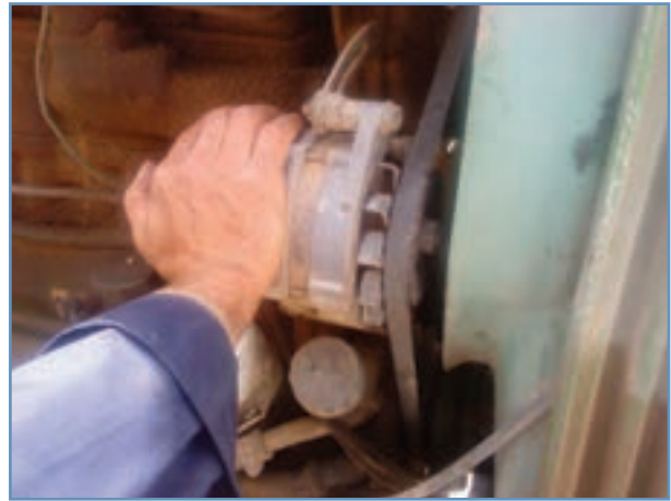
شکل ۳۰-۳- فشار دادن مولد به سمت موتور
