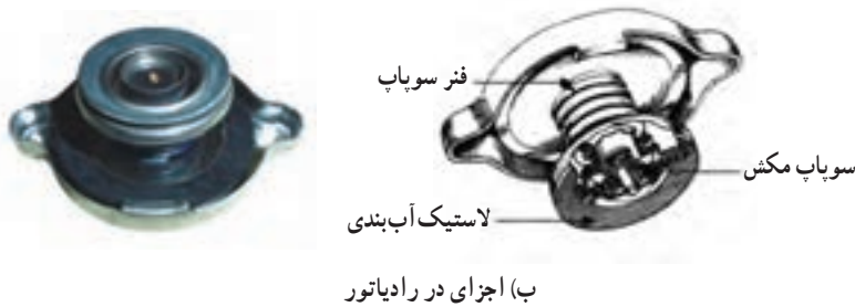
شکل ۳-۵- در رادیاتور و طرز کار سوآپ‌های آن
