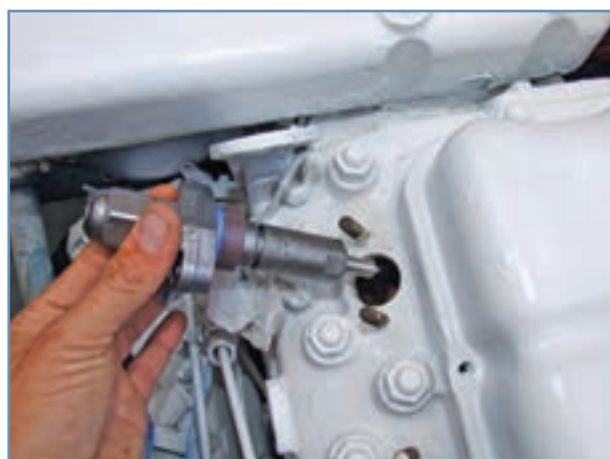
شکل ۲۳-۴- خارج کردن انژکتور
