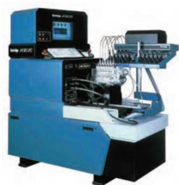
شکل ۲۴-۴ دستگاه آزمودن و تنظیم پمپ انژکتور
