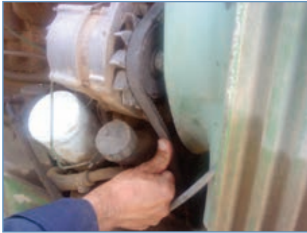
شکل ۲۸-۳- اندازه‌گیری کشش تسمه با فشار انگشت
