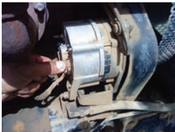
شکل ۲۸-۶- جدا کردن فیش از آلترناتور
