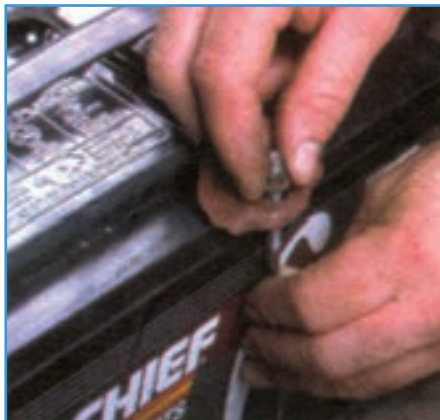
شکل ۹-۶- باز کردن بست نگهدارنده باتری
