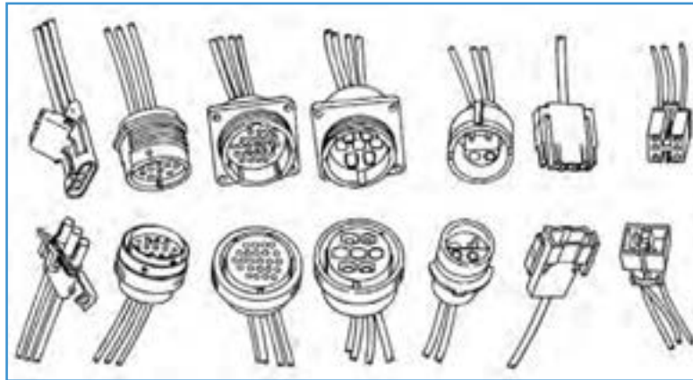
شکل ۵۹-۶- چند نمونه از فیشرهای مورد استفاده در تراکتورها
