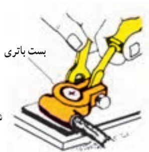
شکل ۶-۶ باز کردن پیچ و مهره بست باتری
