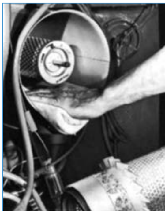
شکل ۱۳-۵- تمیز کردن بدنه صافی با پارچه
