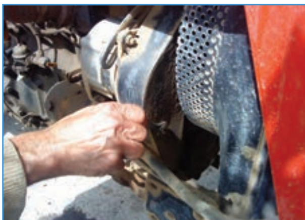
شکل ۳۲-۶ باز کردن روکش محافظ تسمه
