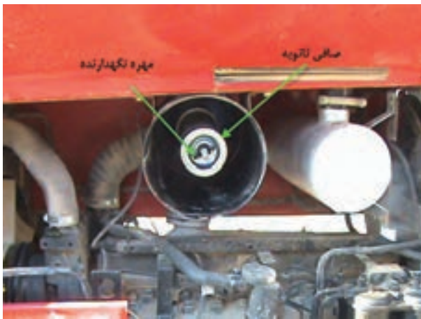
(ب) محل قرار گرفتن صافی ثانویه
