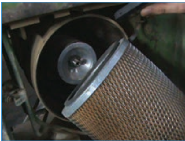
شکل ۵-۵ - صافی خشک و محل قرار گرفتن آن
