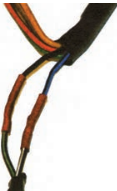
شکل ۶۷-۶- اتصال کامل سیم‌ها با روکش تیوپ عایق
