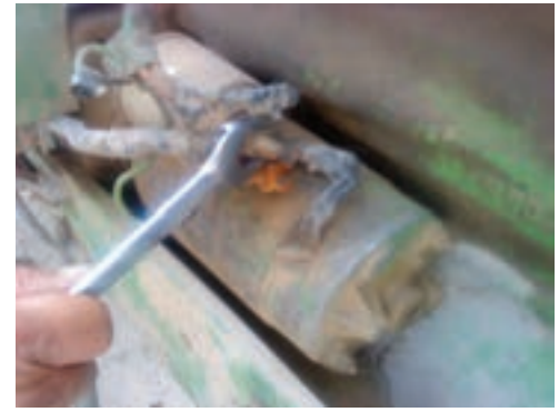
شکل ۵۰-۶- باز کردن کابل مثبت از استارت
