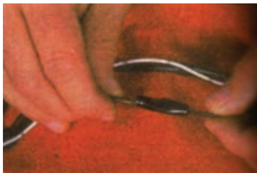
شکل ۶۵-۶- قرار دادن تیوپ عایق روی محل اتصال سیم‌ها
