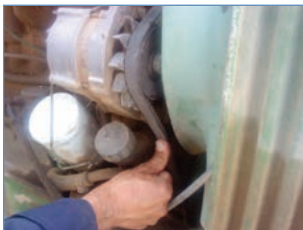
شکل ۳۶-۶ فشار دادن تسمه با شست
