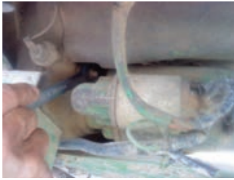
شکل ۵۱-۶- باز کردن پیچ‌های اتصال استارت به بدنه موتور
