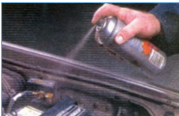
شکل ۱۱-۶- پاشیدن اسپری ضد خوردگی روی بست باتری
