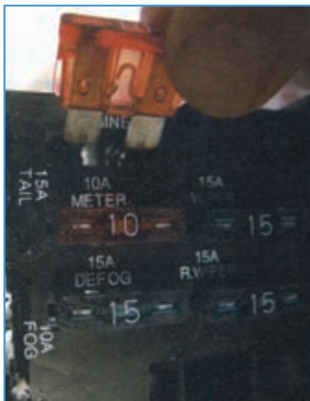
شکل ۶۹-۶- جازدن فیوز در محل آن
