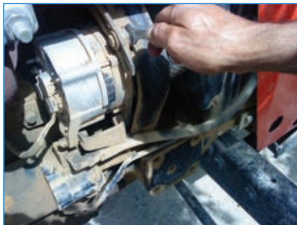
شکل ۲۹-۶ شل کردن پیچ و مهره تنظیم
