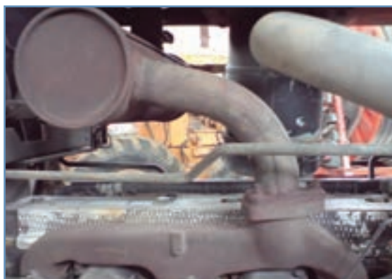
شکل ۳۰-۵- محل اتصال منبع اگزوز به مانیفولد
