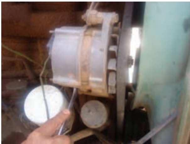
شکل ۳۹-۶ سفت کردن پیچ پایه
