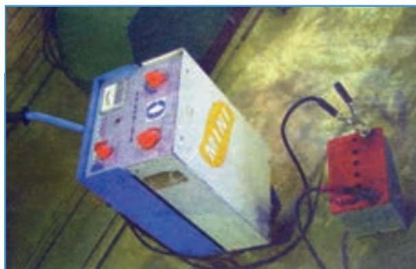
شکل ۱۸-۶ اتصال کابل‌های شارژر به باتری
