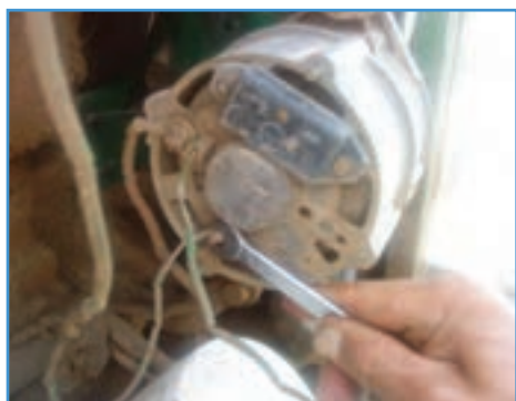
شکل ۳۵-۶ بستن سیم نازک
