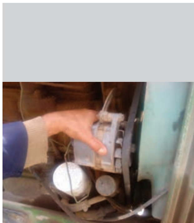
شکل ۳۷-۶ عقب کشیدن آلترناتور
