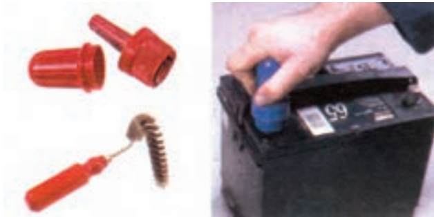
شکل ۲۳-۶- تمیز کردن قطب‌های باتری با ابزار مخصوص
