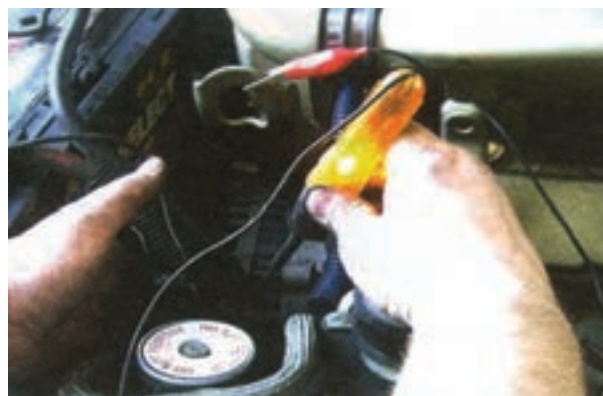
شکل ۷۷-۶- اتصال لامپ آزمایش به مدار
