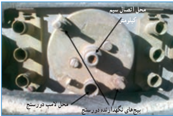
شکل ۸۲-۶- دورسنج از قسمت پشت داشبورد تراکتور U650M
