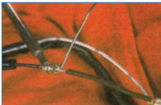
شکل ۶۴-۶- نحوه لحیم کاری سیم‌ها
