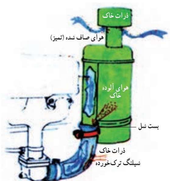
شکل ۱۹-۵- محل بریدگی و سوراخ شدگی در شیلنگ‌ها
