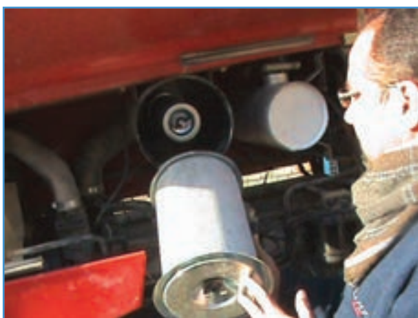
شکل ۱۲-۵- باز کردن مهره نگهدارنده و خارج کردن صافی
