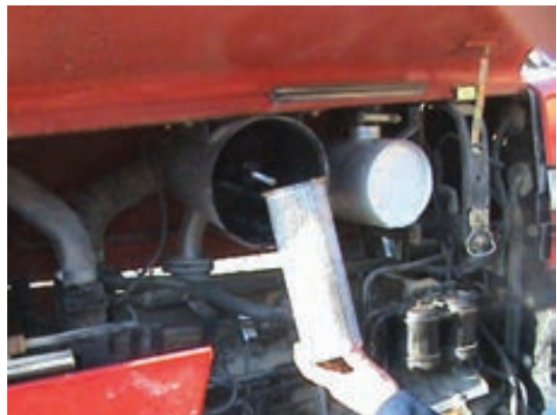
(الف) خارج کردن صافی ثانویه
