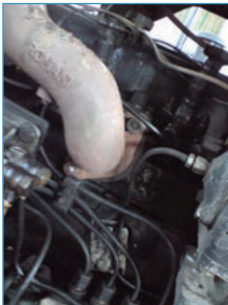
شکل ۳۱-۵- محل اتصال مانیفلد به سرسیلندر تراکتور U650
