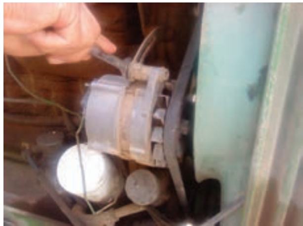
شکل ۳۸-۶ سفت کردن پیچ تنظیم آلترناتور
