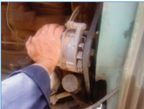
شکل ۳۰-۶ فشار دادن آلترناتور به عقب
