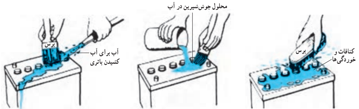
الف) تمیز کردن با برس و آب
