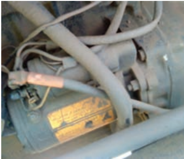
شکل ۶-۴۳- اتصال سیم‌ها از دینام به آفتمات
