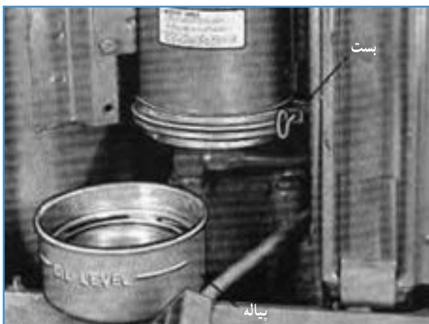
شکل ۱۷-۵- باز کردن پیاله زیر صافی
