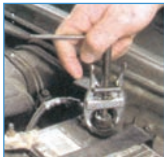
شکل ۶-۷ جدا کردن بست منفی باتری
