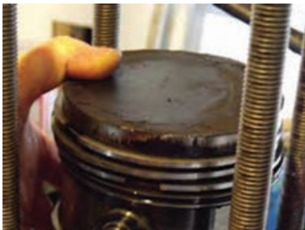
شکل ۲۰۷-۴- رسوبات کربن روی سطح پیستون
