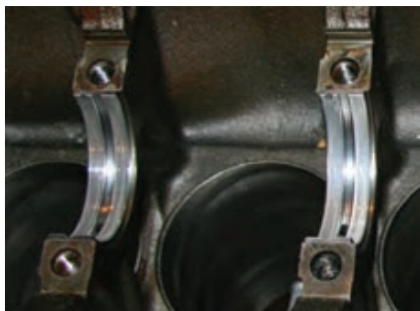
شکل ۱۸۵-۴ جازدن یاتاقان‌های ثابت
