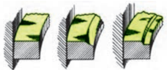
شکل ۱۳۲-۴- فرم خاص در لبه داخلی رینگ
