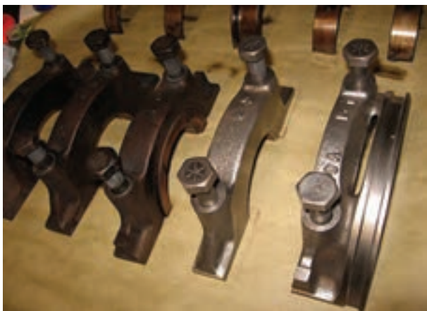
شکل ۱۵۴-۴- چیدن کپه یاتاقان‌ها
