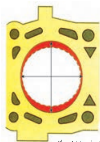
شکل ۱۴۹-۴- وضعیت بیضی شدن سیلندر
