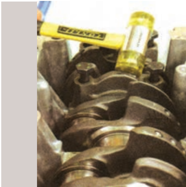
شکل ۱۵۳-۴- ضربه زدن به کپه یاتاقان‌ها با چکش لاستیکی
