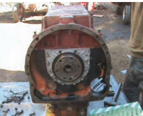
شکل ۱۵۰-۴- انتهای میل لنگ بدون چرخ لنگر
