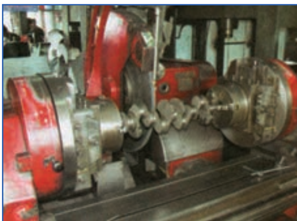
شکل ۱۶۴-۴- دستگاه میل‌لنگ تراشی
