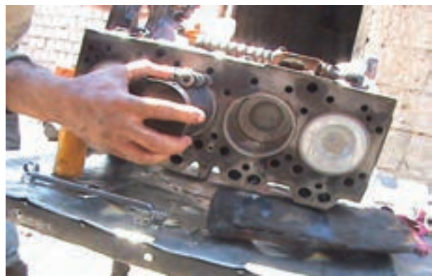
شکل ۱۹۹-۴- چسباندن رینگ جمع کن به سیلندر
