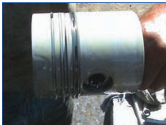
شکل ۱۴۰-۴- روغن‌کاری همه رینگ‌ها و پیستون
