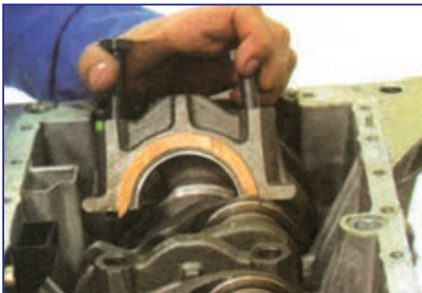
شکل ۱۸۱-۴- برداشتن کپه یاتاقان دارای بغل یاتاقانی
