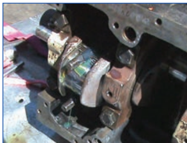
شکل ۲۰۳-۴- جا زدن شاتون روی میل لنگ
