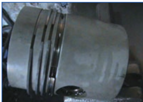
شکل ۱۳۹-۴- ترتیب قرار گرفتن رینگ‌ها روی شیار پیستون
