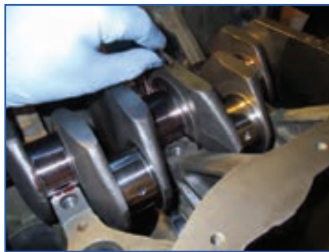
شکل ۱۸۳-۴- خارج کردن بغل یاتاقانی
