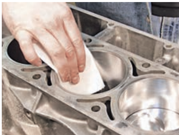
شکل ۲۰۸-۴- تمیز کردن داخل سیلندر
