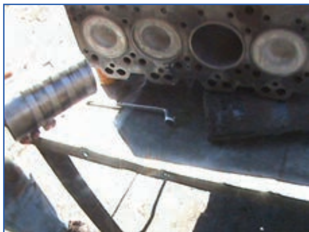
شکل ۲۰۲-۴- برداشتن رینگ جمع کن بعد از داخل شدن پیستون به سیلندر
