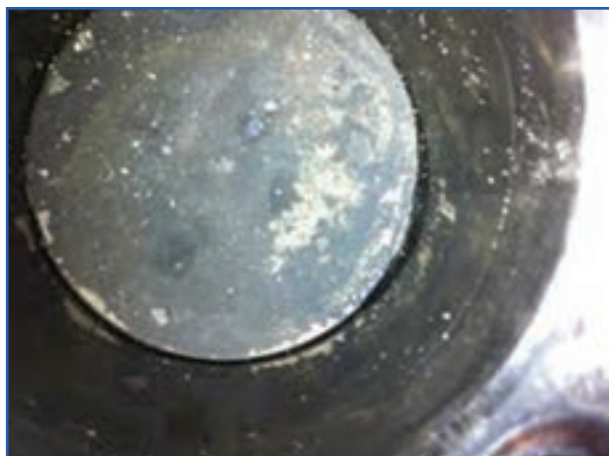
شکل ۲۰۶-۴- رسوبات کربن روی سطح پیستون
