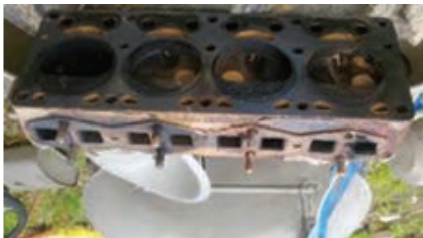
شکل ۲۰۹-۴- رسوبات کربن سطح سرسیلندر
