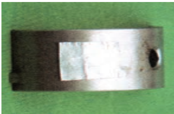
شکل ۱۷۴-۴ قرار دادن لایه با ضخامت مناسب پشت یاتاقان
