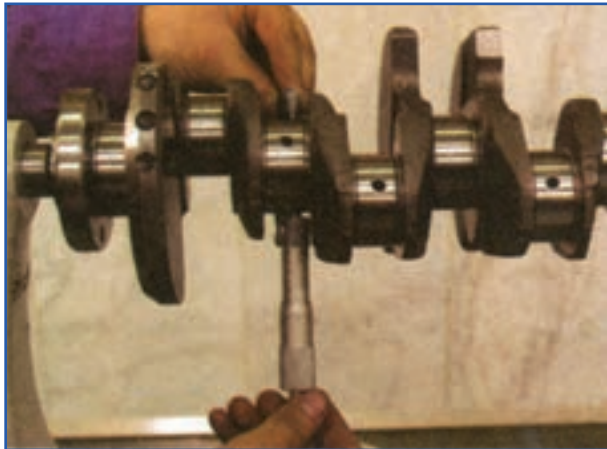
شکل ۱۶۲-۴- اندازه‌گیری قطر محورهای میل‌لنگ
