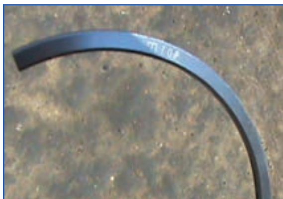
شکل ۱۳۴-۴- علامت TOP روی رینگ
