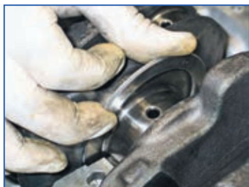
شکل ۱۸۴-۴- جازدن بغل یاتاقانی
