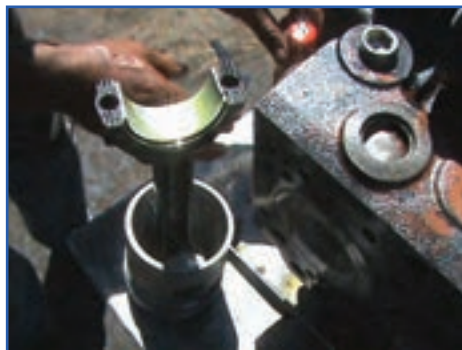
شکل ۱۹۲-۴- روغن‌کاری رینگ‌ها، پیستون و یاتاقان
