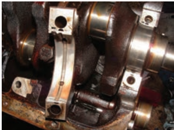
شکل ۱۸۲-۴- باز کردن کپه یاتاقان نابت
