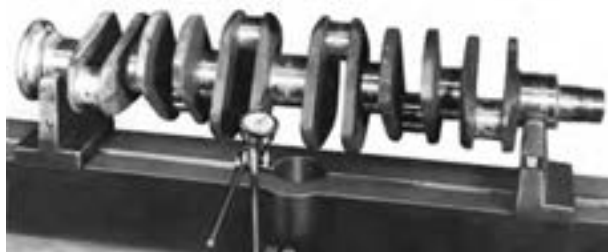
شکل ۱۶۰-۴- دستگاه اندازه‌گیری تاب میل‌لنگ
