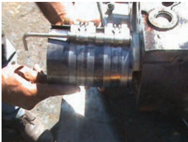
شکل ۱۹۸-۴- جمع کردن رینگ‌ها با رینگ جمع کن
