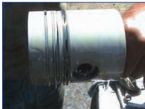
شکل ۱۹۲-۴- روغن‌کاری رینگ‌ها، پیستون و یاتاقان
