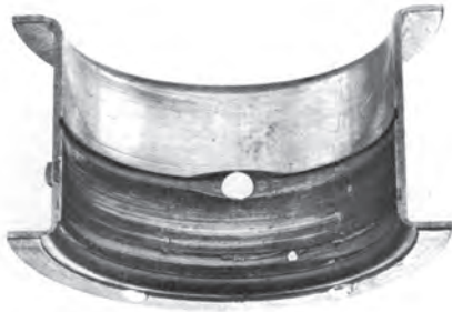
شکل ۱۶۵-۴- خط به دلیل نفوذ ذرات ریز و درشت بین میل‌لنگ و یاتاقان
