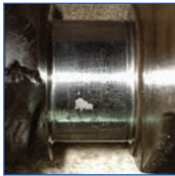
ب) پوسته کردن لایه سخت لنگ
