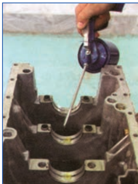
شکل ۱۸۷-۴ روغن کاری یاتاقان‌های ثابت
