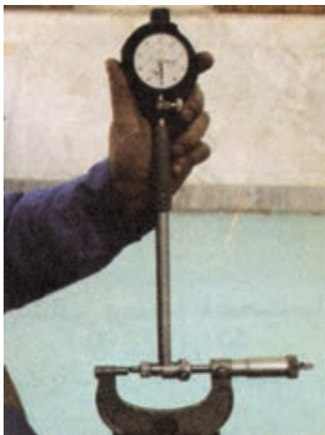
شکل ۱۷۱-۴ اندازه‌گیری قطر میل‌لنگ به وسیله میکرومتر و انتقال آن روی ساعت اندازه‌گیری
