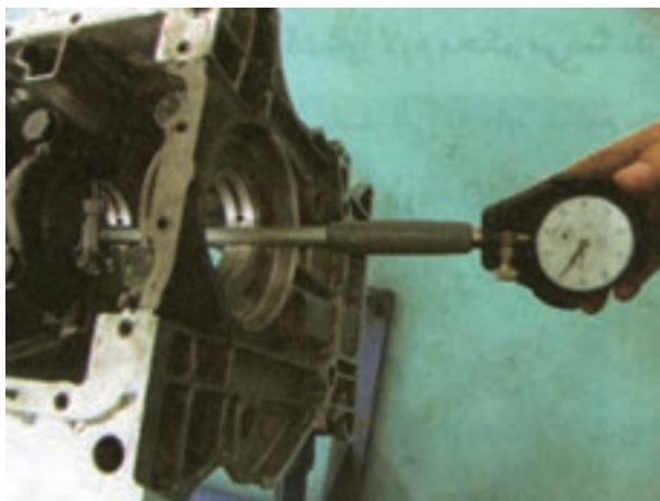
شکل ۱۷۲-۴ اندازه‌گیری قطر داخلی یاتاقان با ساعت اندازه‌گیری
