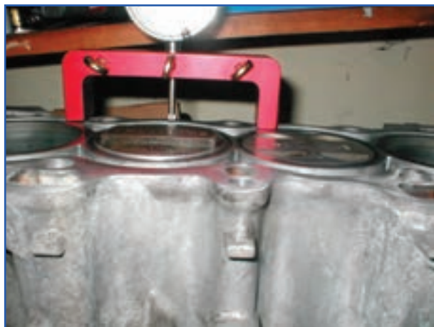
شکل ۲۰۵-۴- کنترل ارتفاع پیستون
