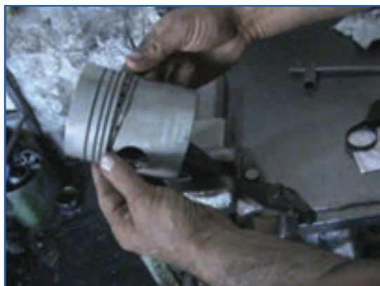
شکل ۱۳۸-۴- جا زدن رینگ با دست
