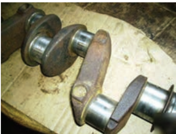
شکل ۲۱۰-۴- میل‌لنگ با رسوبات کربن
