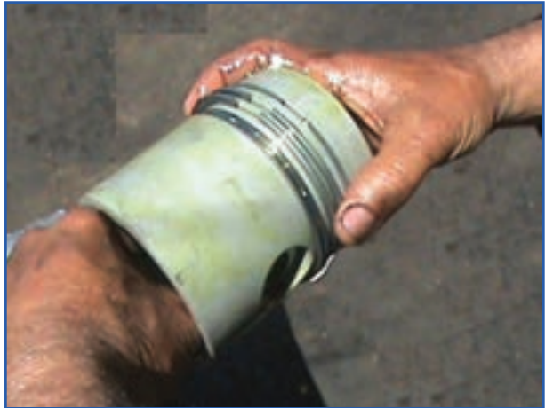
شکل ۱۹۶-۴- تنظیم کردن دهانه رینگ‌ها
