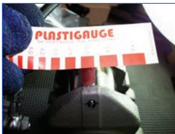
شکل ۱۷۶-۴- اندازه گیری دو بهنی پلاستی گیج شابلون
