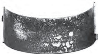
شکل ۱۶۸-۴- اثرات سوختگی روی یاتاقان
