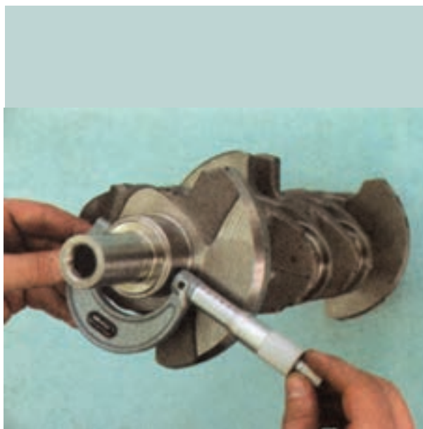
شکل ۱۷۱-۴ اندازه‌گیری قطر میل‌لنگ به وسیله میکرومتر و انتقال آن روی ساعت اندازه‌گیری
