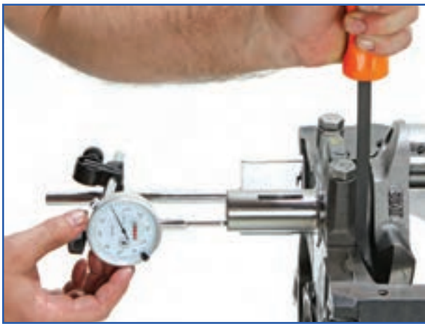
شکل ۱۷۹-۴- اندازه‌گیری لقی طولی میل‌لنگ با ساعت اندازه‌گیری
