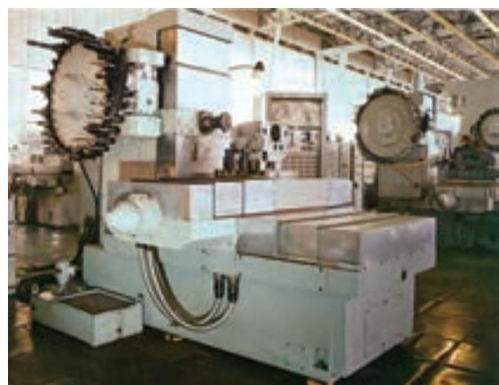
تصویر، متعلق به ماشین‌آلات ابزارگردانی است که در کمتر از ۵ ثانیه انواع ابزار خود را به صورت خودکار از بین شصت الی یکصد ابزار انتخاب، جایگزین در ابزارگیر و سپس با حرکت‌های طولی میزشان از یک تا بعضاً ده متر، کار تراش‌کاری، سوراخ‌کاری و... را انجام می‌دهند.
